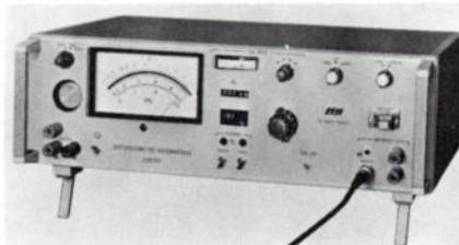
**LEA** : distorsiomètre basse fréquence automatique, modèle EHD 55. [5507]
