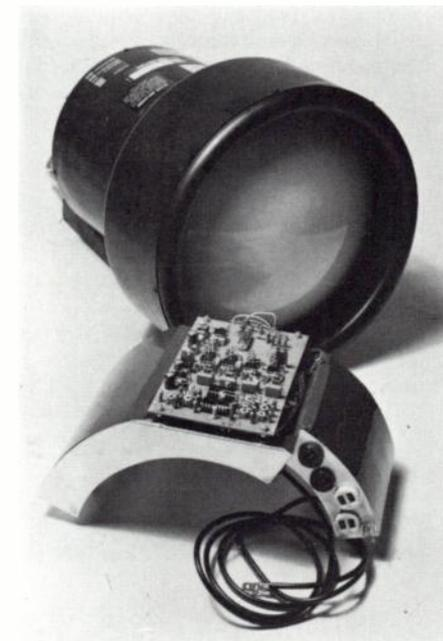
**Brandenburg** : Module d'alimentation pour tubes intensificateurs d'image (entrée + 24 V 5 sorties : + 50 à + 500 V ; + 350 à + 1 700 V ; + 2,9 à 10,8 kV ; + 30 kV et + 2,5 à + 3 kV) modèle 831. [5425]
