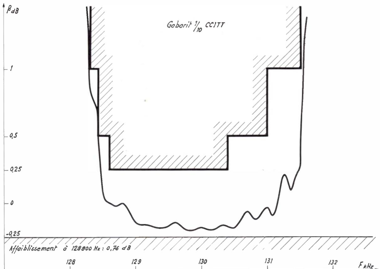
Fig. 16. – Courbe expérimentale obtenue avec synthèse paramétrique sans bobine (cf. fig. 15).
