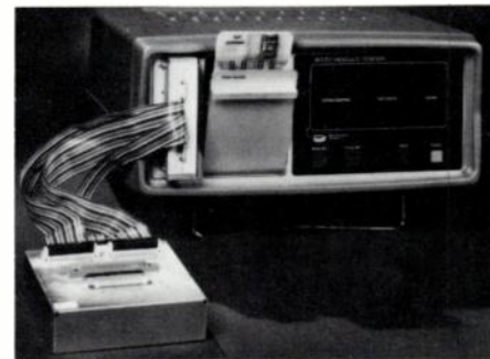
Bendix : système portable de test de cartes logiques (TTL-MOSC, jusqu'à 256 broches) modèle 9070. [6651]
