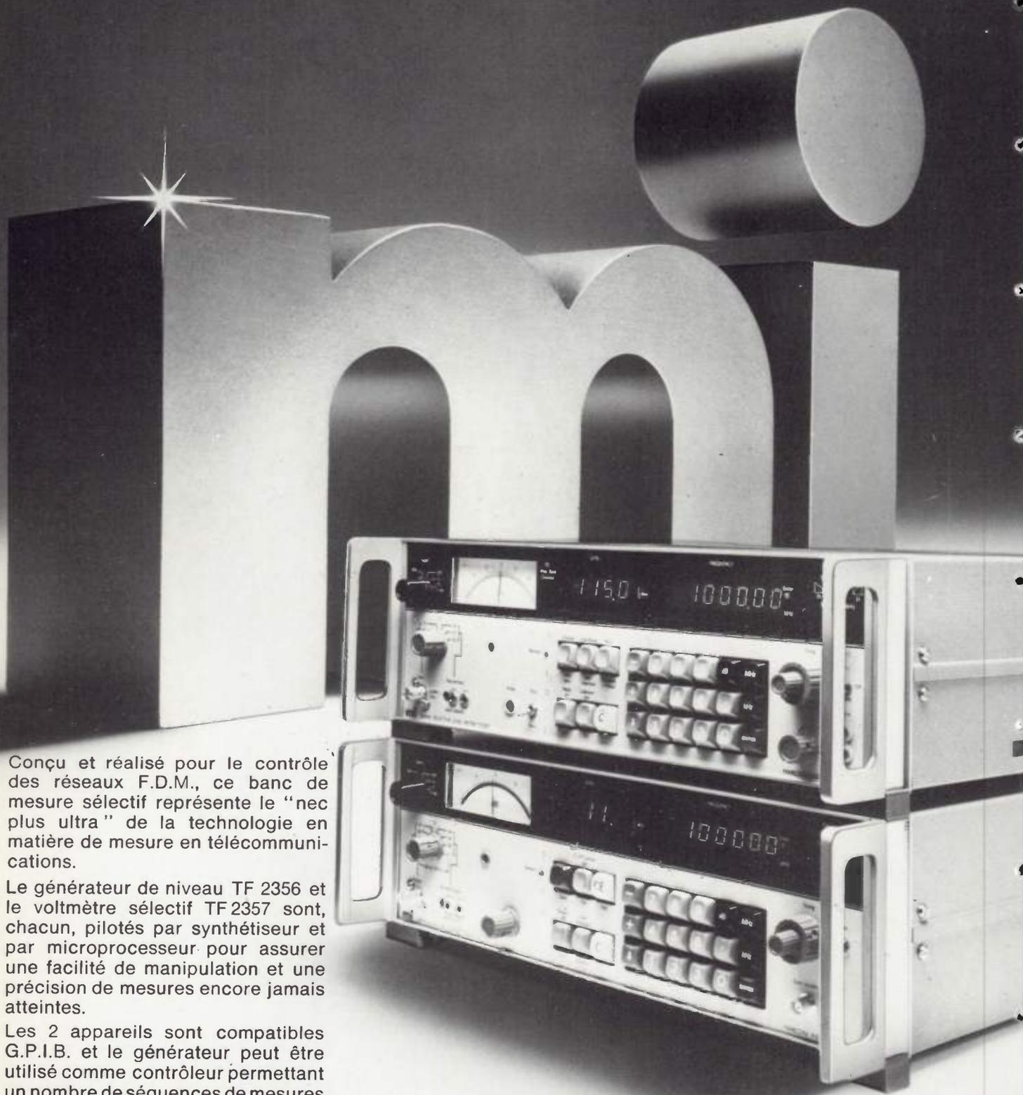
Conçu et réalisé pour le contrôle des réseaux F.D.M., ce banc de mesure sélectif représente le "nec plus ultra" de la technologie en matière de mesure en télécommunications.
