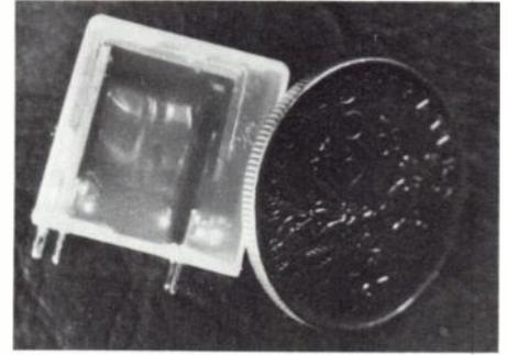
**Omron** : Relais pour circuit imprimé (5 A sous 110 V alternatifs ; inverseur, 2 inverseurs ou 1 contact travail), modèle LC 1. [7702]
