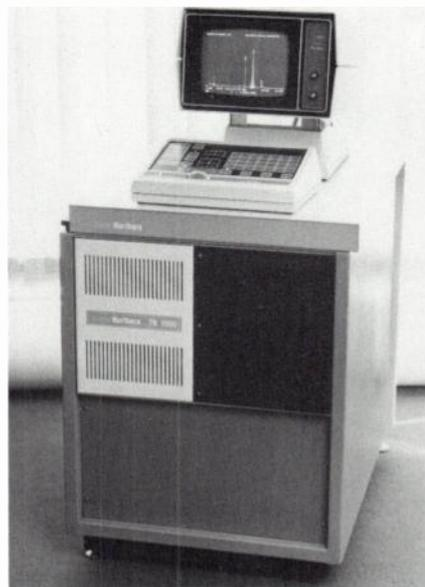
**Northern Tracor** : Analyseur multicanaux pour spectrométrie modèle TN 2 000. [7780]
