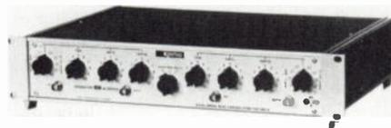
**Kemo** : Filtre de fréquence passe-haut passe-bas à 2 voies identiques (atténuation : 24, 36 ou 48 dB/octave ; 10 MHz-100 kHz ou en option 1 MHz-10 kHz). [7777]
