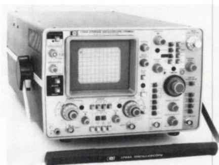
**Hewlett Packard** : Oscilloscope à mémoire (100 MHz, 2 voies) modèle 1744 A. [7766]
