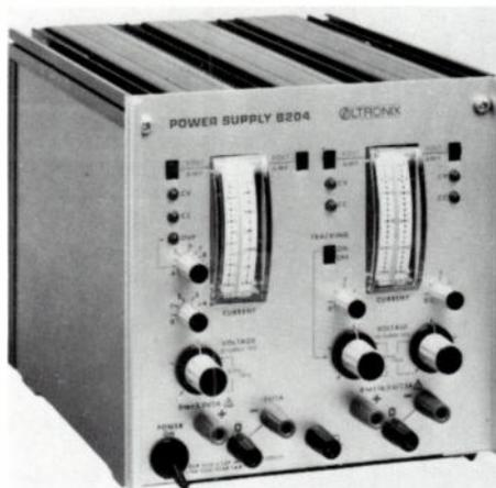
Les sorties 0 à ± 16,5 V peuvent être ajustées séparément ou être utilisées comme tensions asservies qui se suivent. Dans ce dernier cas, une protection optimale de la charge est obtenue car si à la suite d'une surcharge, l'une des tensions chute, l'autre la suit et se limite à la même valeur.
