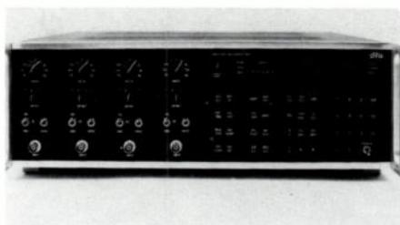
L'enregistreur de transitoires DIFA, modèle TR 1010, peut être aisément associé, grâce à une interface IEEE-488-1975 à tout système automatisé. Ses domaines d'application sont l'électrotechnique, la balistique, les essais mécaniques, le génie civil, la surveillance médicale, etc...
