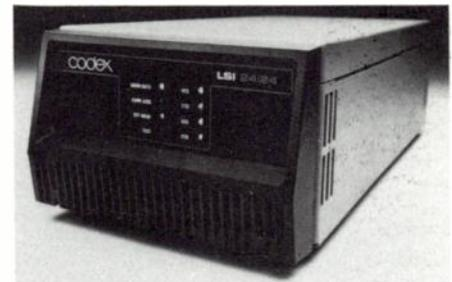
**Coedex** : Modem duplex intégral à 2400 bits/s pour lignes réseau ou spécialisées à 2 fils, modèle LSI 24/24. [9962]
