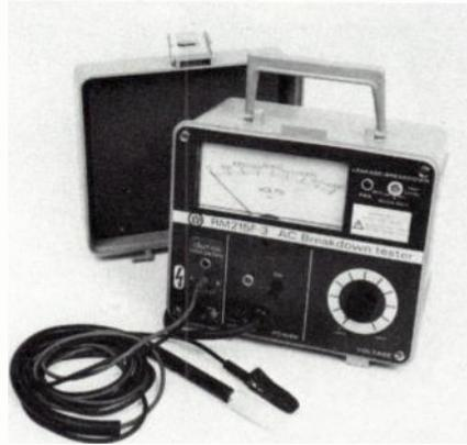
**AVO** : Testeur d'isolement et de tension de rupture (50 V à 4 000 V, analogique) modèle RM 215 F 3. [9969]
