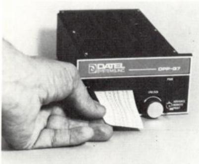
La tête thermique imprime à une température de 200 °C pendant 0,01 s et sa durée de vie est supérieure à 3 000 000 de lignes.
