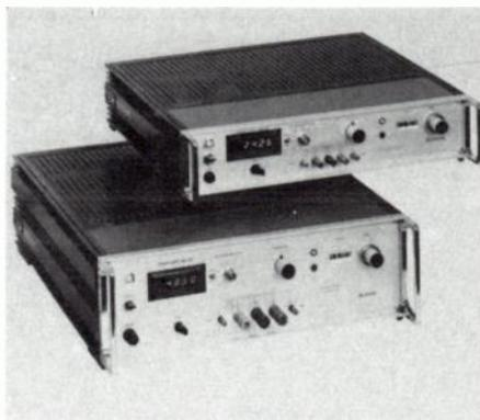
Un rendement élevé est obtenu grâce à l'utilisation d'un pré-régulateur à thyristors. Ces alimentations de faible poids et d'encombrement réduit sont prévues pour le montage en baie de 19" ou comme alimentation sur table. Le fonctionnement en source de courant ou en source de tension fait appel à des circuits à hautes performances. Les deux modes de fonctionnement sont indiqués par des diodes électroluminescentes. Notons enfin que les RAPAC peuvent être télécommandés ou programmés à distance.
