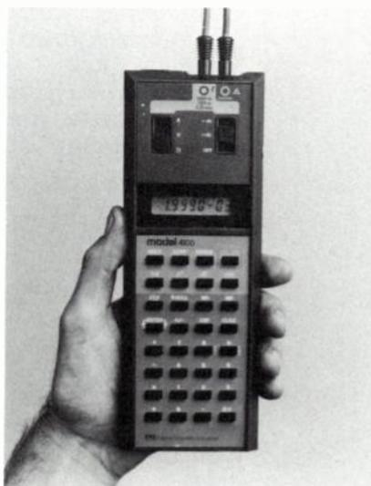
Le 4100 peut également être relié à une unité imprimante. Le clavier de cet instrument comporte 11 touches spéciales affectées aux conversions. Le multimètre proprement
