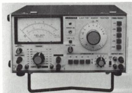
**Leader** : Appareil de test pour chaînes basse fréquence à haute fidélité (générateur : 10 Hz-1 MHz; millivoltmètre alternatif, atténuateur) modèle LAV 191 Audio Tester. [1037]
