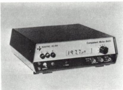
Ce pont possède un circuit de protection contre les condensateurs chargés jusqu'à 2500 et 50 V au delà de 2 μ F.
