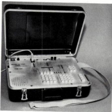
Les valises de test TXM 1120 et TXM 1121 développées par la division Travaux Extérieurs de Thomson-CSF et commercialisées par sa division Sescosem sont des instruments autonomes, destinés au contrôle, à la mise au point et à la maintenance des systèmes construits autour du microprocesseur MOS - 8 bits SFF 96800 équivalent du
