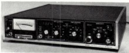
pourcentage de la pleine échelle (0 à 150 %, linéarité du convertisseur). La suppression de 0 est unique et permet de dilater chaque bond de 10 % (0 à 90 %) afin de couvrir la gamme de sortie analogique 0-10V sans perte de précision. Les options interface IEC Bus, sorties BCD, programmation de la sensibilité et ratiomètre peuvent être incorporées dans l'appareil tandis que les préamplificateurs
