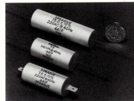
petits que les condensateurs huile à boîte métallique qu'ils sont destinés à remplacer ces nouveaux modèles utilisent un film diélectrique Polyester métallisé sous tube plastique ininflammable, bouché époxy. Les unités sont munies soit de bornes-fil axiales pour circuit imprimé, soit de broches «quick-connect» standard 6,35 mm pour les appareils électriques usuels.
