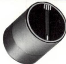
Tête de lecture de graduation pour la Société SFIM. Le dispositif d'un  $\varnothing$  de 20 mm est constitué de 5 nappes de fibre de 50  $\mu\text{m}$ . Le pas des 4 nappes superposées est tolérancé de  $\pm 4 \mu\text{m}$ .
