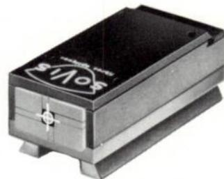
Système transformateur de coordonnées pour le CEA entre l'objectif et une caméra à balayage ultrarapide pour filmer les explosions nucléaires. Réalisé en fibre de 100  $\mu\text{m}$ .
