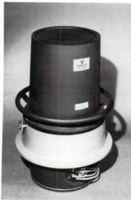
Fig. 4. — Photographie du tube TH 3517.
