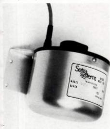
de mesure est en céramique Setraceram et constitue une capacité électrique; le circuit électronique mesurant la variation de capacité est un circuit à balance de charge, exécuté en circuit intégré. La précision est de 0,06 % PE, définie
