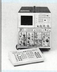
Annoncé par Tektronix, la 7854 est le premier oscilloscope associant dans un même chassis les avantages d'un oscilloscope «hautes performances» à ceux de la numérisation et au traltement des signaux par calculateur. La puissance et la souplesse de cette association font du 7854 un outil remarquable.
