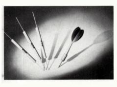
La société Caddock, représentée par Bicel, a étendu sa gamme de résistances haute tension de précision avec le modèle MG 780 qui, pour une longueur de 79.40 mm et un diamètre de 8 mm, a les caractéristiques suivantes : Puissance : 7.5 Watts, tension: 15,000 Volts, gamme de valeur ohmique : 600 ohms à 750 Megohms, tolérance : 1 % standard (jusqu'à 0,1 % sur demande) et coefficient de température : 80 ppm (appairage possible jusqu'à 10 ppm).
