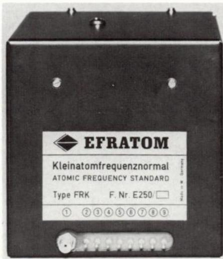
rubidium, la lumière est absorbée et le courant chute dans le détecteur. Cet effet est utilisé, après amplification, pour corriger la fréquence du quartz et obtenir une excellente stabilité du signal étalon. L'oscillateur délivre un signal sinusoïdal de 10 MHz (10/5/1 et 0,1 MHz pour le modèle FRT). Il a une stabilité à court terme de  $10^{-12}$ , une consommation de 13 W et un volume de 1 dm<sup>3</sup>.
