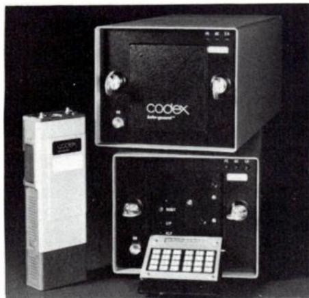
transmission des données inintelligible lors d'une interception, en transformant celles-ci, préalablement, en un code indestructible, par chiffrement à l'origine et déchiffrement chez le destinataire. Il utilise
