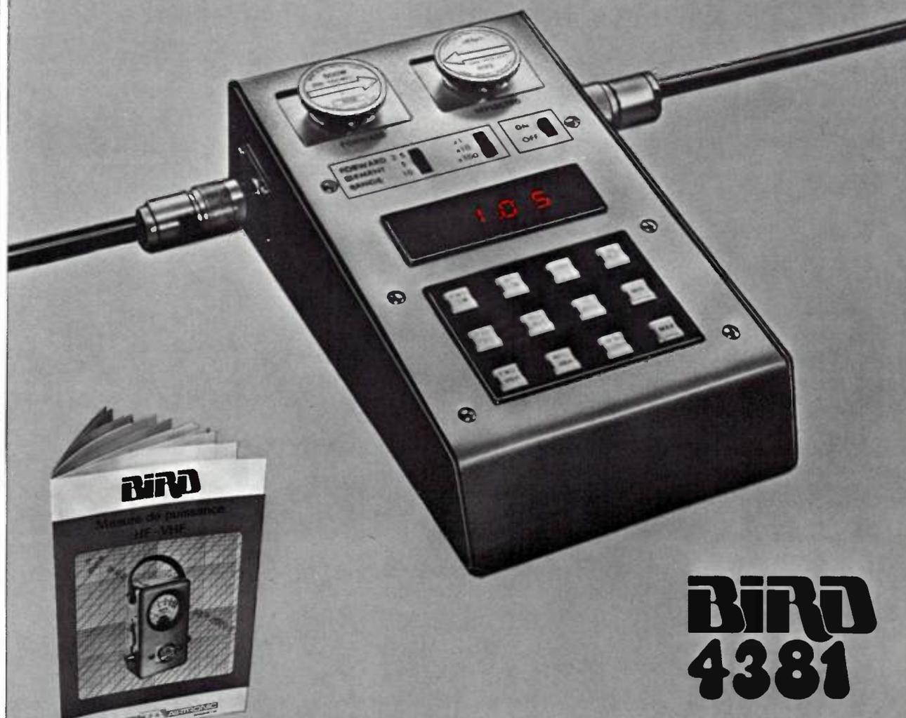
Le BIRD 4381 est un multimètre HF portable piloté par micro-calculateur. Il mesure les puissances directe et réfléchie, CW, crête, dBm, de 100 mW à 10 kW sur une bande de fréquences de 450 Hz à 2,3 GHz. Il calcule aussi le R.O.S., et met en mémoire les mini et les maxi de la mesure.
