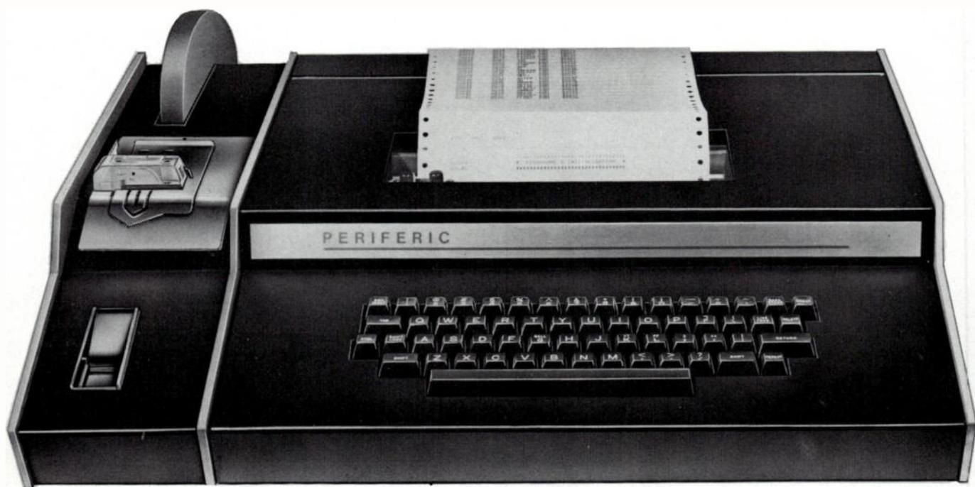
Le ZIP 30 existe en version ASR et KSR. Impression par matrice 5 x 7. Frappe majuscule, minuscule en option. Zone d'impression, 80 colonnes. Entraînement friction ou picots. Clavier QWERTY ou AZERTY.
