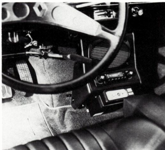
Fig. 5. — Récepteur autonome PAAC couplé à un autoradio.
