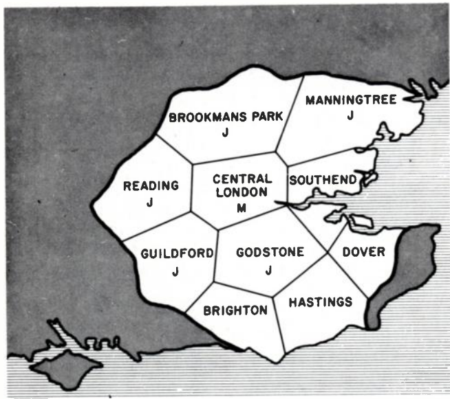
Fig. 2. — Séquence d'émission. Émetteur de message (M). Émetteur de brouillage (J).
