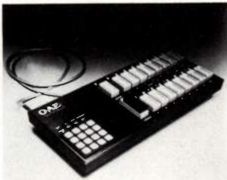
tue avant duplication le test électrique des courants de fuite vers la masse et la tension d'alimentation de chaque broche d'adresse, et de donnée, le test électrique des niveaux de courant et de tension sur chaque broche, de la mémoire. Le temps total d'exécution de la séquence automatique complète de duplication est de 130 s pour la mémoire 2708 et de 122 s pour la mémoire 2716.
