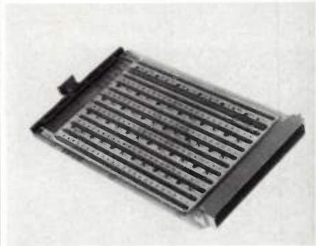
ou double) additionnelles au pas de 2,54 mm. Ceci permet l'implantation de tous circuits intégrés ayant un entraxe de 2,54 mm à 22,86 mm. Le format simple (8136 UVG 5) possède 13 rangées de 49 contacts et des points d'alimentation et de masse. Le format double (8136 UVG 6) comporte 30 rangées de 49 contacts ainsi que des points d'alimentation et de masse. Ces cartes sont fournies avec ou sans connecteur DIN 64 ou 96 points, et avec un extracteur permettant les points de test
