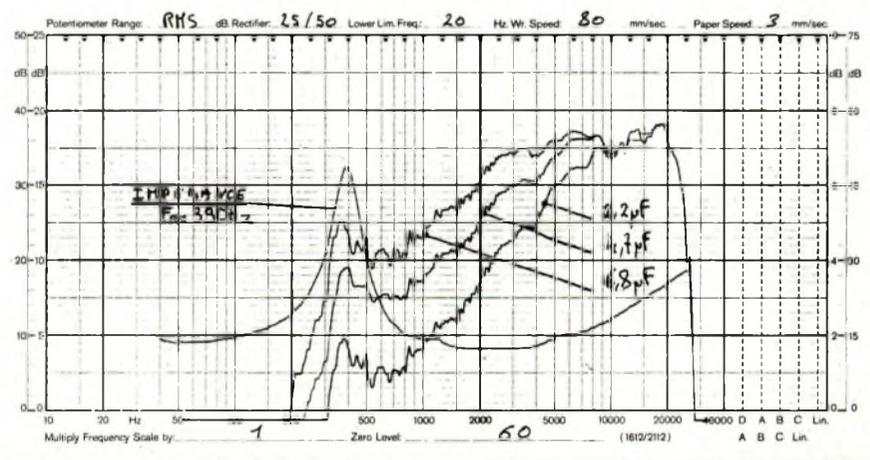
Ce tweeter qui résonne à 390 Hz ne devra pas être filtré trop bas, en effet une coupure à 6 dB/oct. vers 2 kHz peut provoquer une remontée du niveau.
