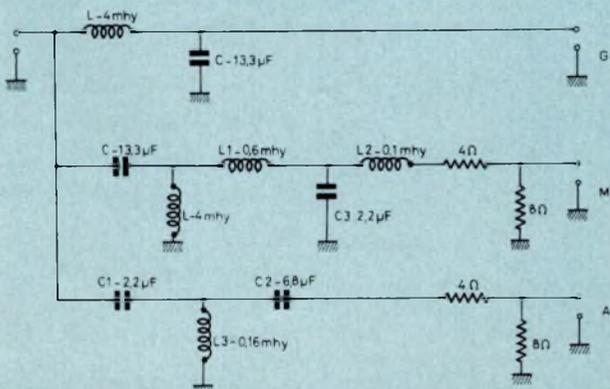
**Caractéristiques du filtre :** 3 voies 600 Hz - 6 000 Hz - 8 Ω. Pont diviseur 4 Ω série ; 8 Ω parallèle. Passe-bas grave 12 dB/oct. ; passe-haut médium 12 dB/oct. ; passe-haut médium 12 dB/oct. ; passe-bas 18 dB/oct. ; passe-haut aigu 18 dB/oct.
