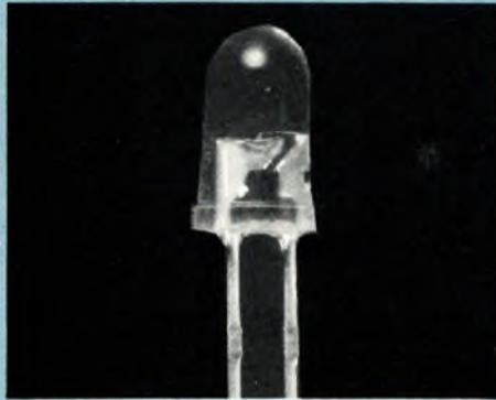
**Diode électroluminescente LED ultra-lumineuse de rendement élevé. La luminosité est telle qu'une utilisation en extérieur, à la lumière du jour est possible. Conçue par la firme japonaise Stanley, sa haute luminosité est conservée même sous de faibles consommations, de l'ordre du milliampère.**
