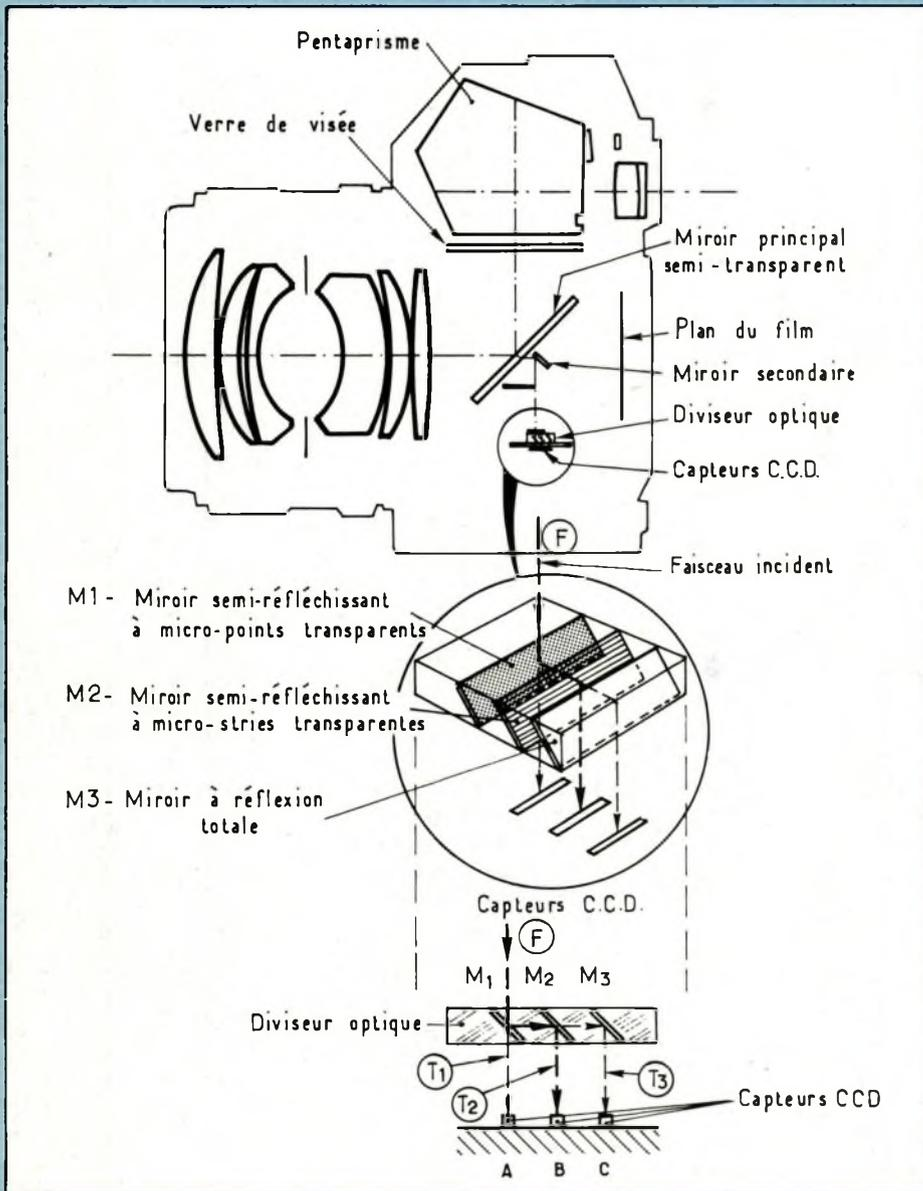
Fig. 7. Système à mise au point rapide, assisté par capteurs CCD positionnés dans un plan homogène à celui du film, et utilisés pour détecter les variations de netteté.
