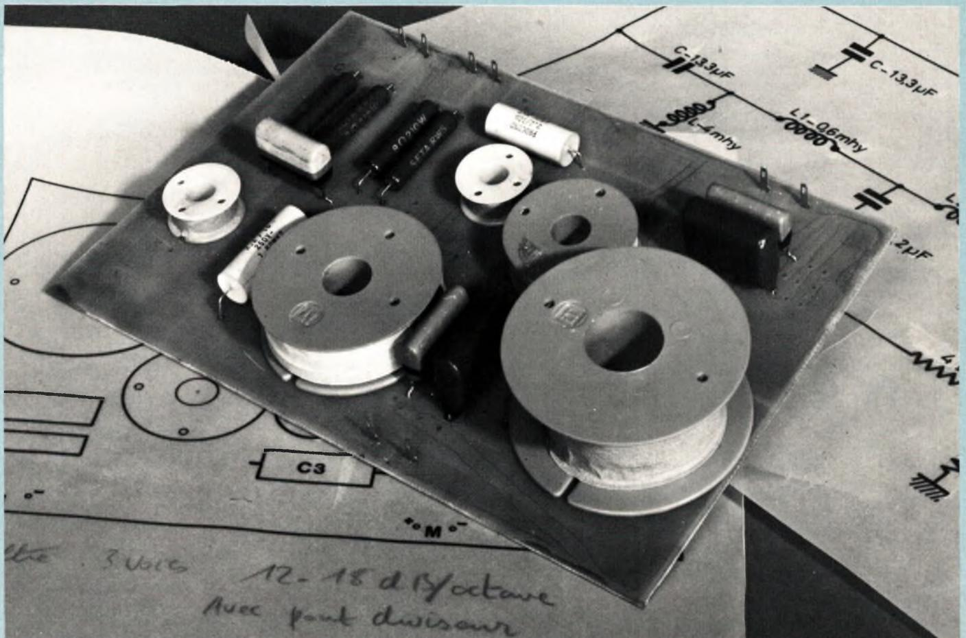
**L**a mise au point d'un filtre passif est très délicate. Il est nécessaire de choisir correctement les paramètres :
