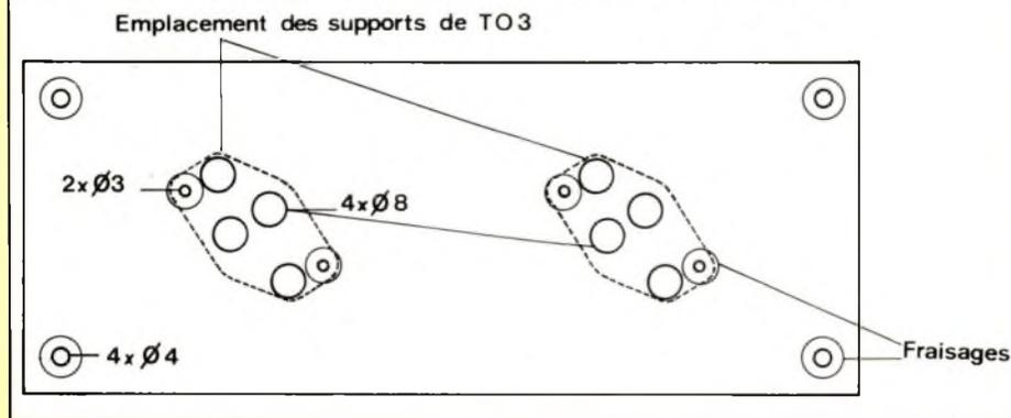
Fig. 8. Le flasque droit reçoit deux supports pour transistors TO3.
