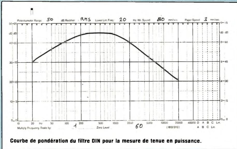
Courbe de pondération du filtre DIN pour la mesure de tenue en puissance.
