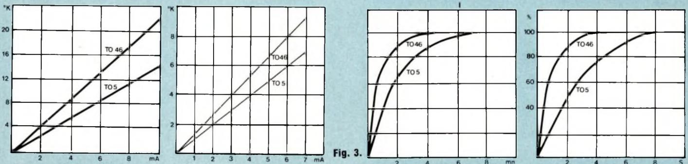
Élévation de la température interne en fonction des courants de shunt et de sortie. Constante de temps thermique selon le milieu ambiant : air et huile.
