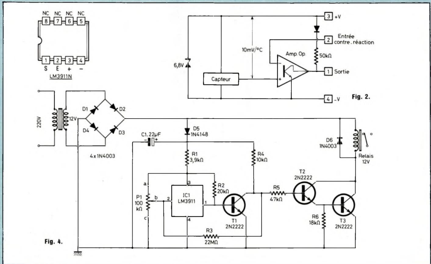
Schéma de principe retenu pour notre application. Synoptique et brochage du LM 3911.
