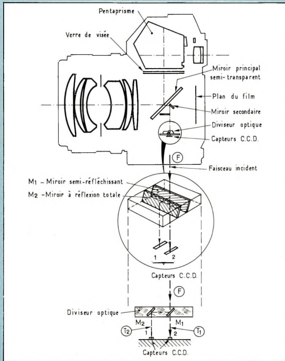
**Fig. 5.** Sur les reflex les plus récents, la mise au point est contrôlée au moyen de capteurs CCD utilisés de manière à analyser les différences de contraste distinguant une image nette d'une image floue.
