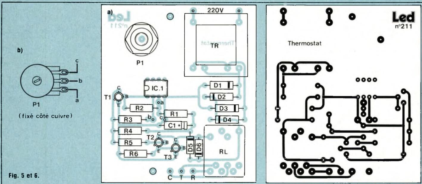
Circuit imprimé et implantation ont été prévus pour un fonctionnement autonome (alimentation).
