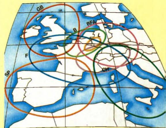
▲ Tracé des empreintes des faisceaux (courbes - 103 dB W/m<sup>2</sup>) couvrant l'Europe occidentale.
