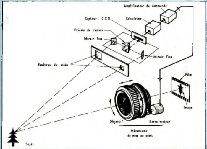
Fig. 4. Les systèmes à capteurs CCD, de conception classique, procèdent par analyse des positions respectives occupées, sur leur réseau de photo-diodes, de l'image d'une scène d'ensemble et de celles de l'un de ses éléments constitutifs sur lequel est pointé la visée.
