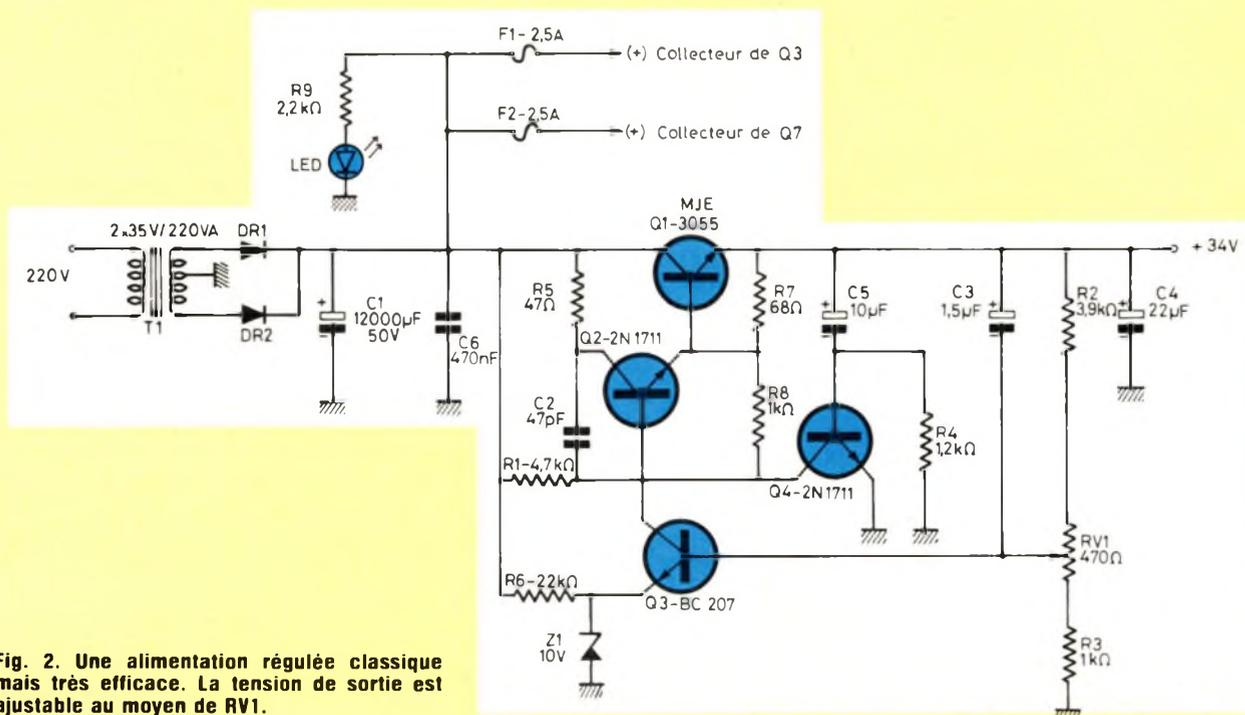
Fig. 2. Une alimentation régulée classique mais très efficace. La tension de sortie est ajustable au moyen de RV1.
