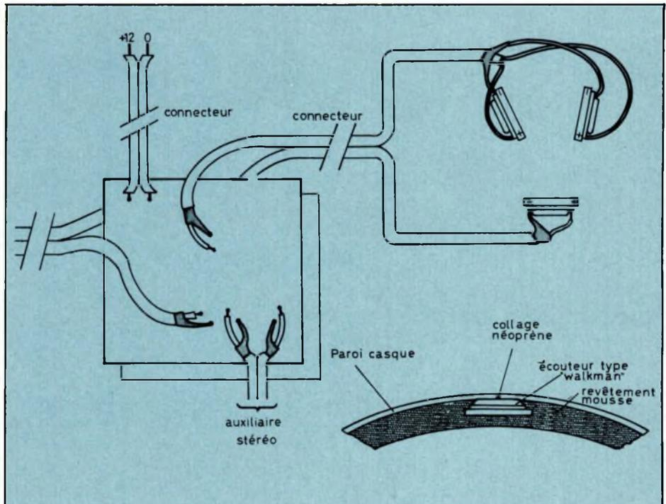
On distingue, en haut à droite les éléments d'équipement d'un casque : deux haut-parleurs, un microphone. La liaison vers les plaquettes (superposées) s'effectue en blindé double via un connecteur de sécurité. Les plaquettes sont liées mécaniquement et électriquement par des liaisons rigides au niveau de l'alimentation et de l'auxiliaire (voir photos). En bas, à gauche, coupe de l'implantation des transducteurs.
