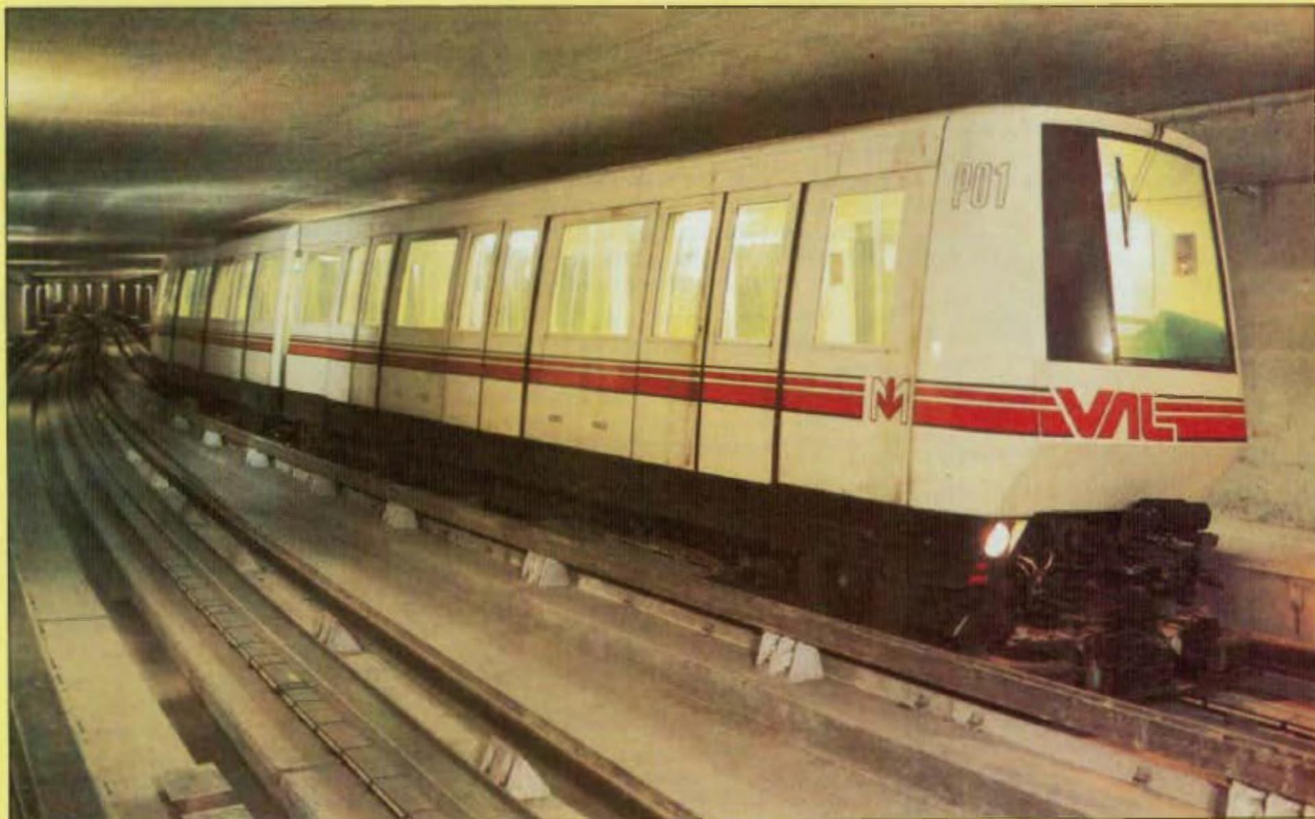
Aspect extérieur d'une rame VAL. On ne distingue pas de poste de conduite, mais l'automatisme d'attelage apparaît nettement.
