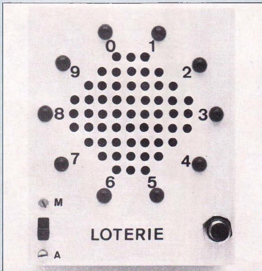
**D**ix leds montées en cercle autour d'un haut-parleur vont s'allumer successivement en faisant entendre un toc à chaque allumage produisant un effet semblable à une roue de loterie comme il y avait jadis dans les foires.
