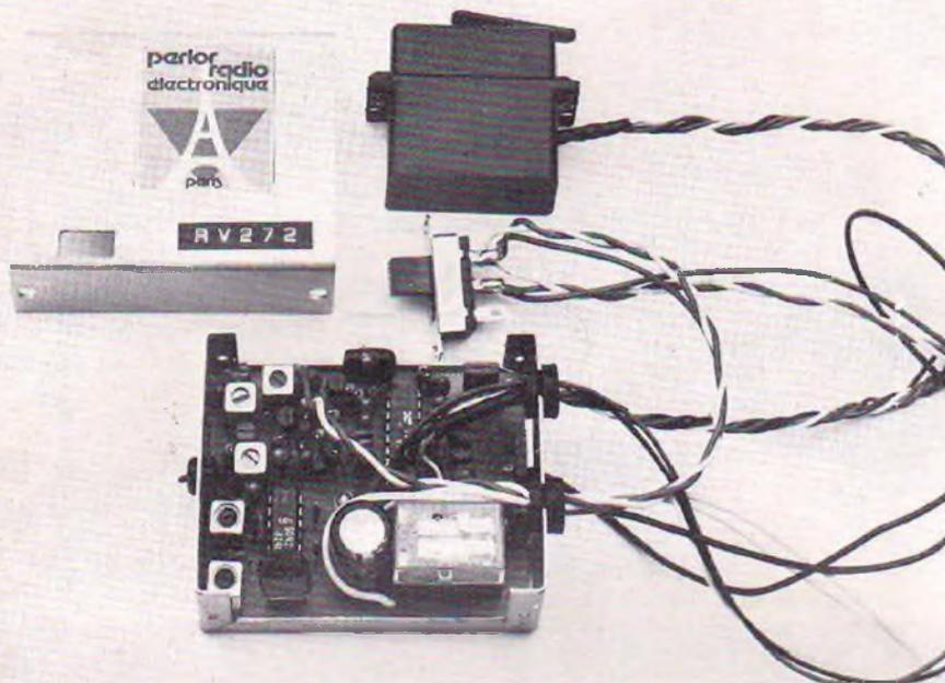
Dans notre précédent numéro nous vous avons proposé l'émetteur A.M. 272 qui fait partie d'un ensemble de radiocommande pour maquette de bateau ou voiture à propulsion électrique, voici donc la suite de cet article qui porte sur le récepteur-variateur R.V. 272. Cet ensemble, rappelons-le, est du type « deux voies », c'est-à-dire qu'il peut assurer la commande de deux fonctions à distance : la direction et la propulsion.
