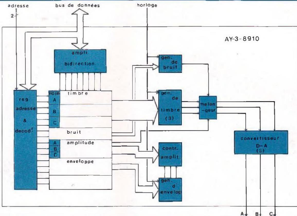
Figure 3 : Bloc diagramme du S.G.B.
