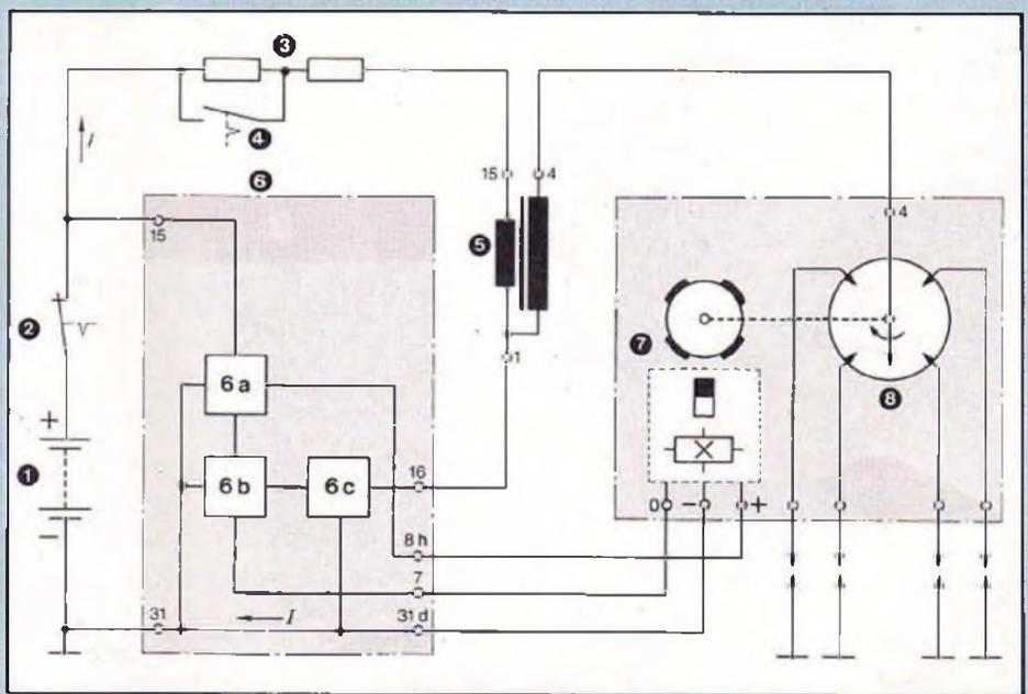
**Fig. 5 : Allumage transistorisé par bobine, sans rupteur mécanique (TSZ-h). Schéma fonctionnel, avec désignation des bornes. En gras : circuit primaire.**
