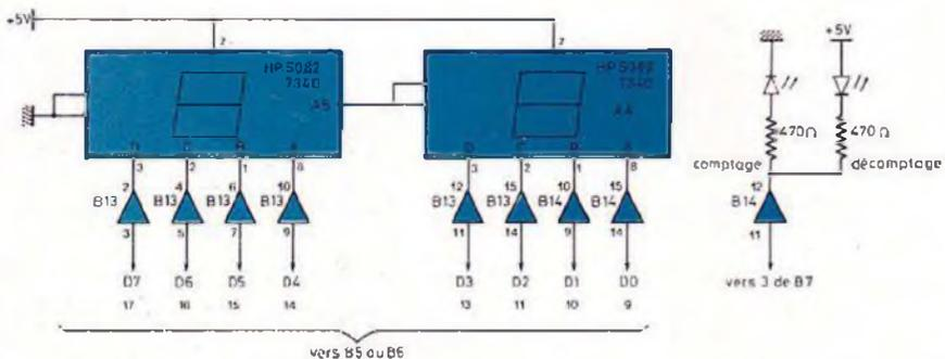
Schéma de principe du clavier hexadécimal 8 bits.
