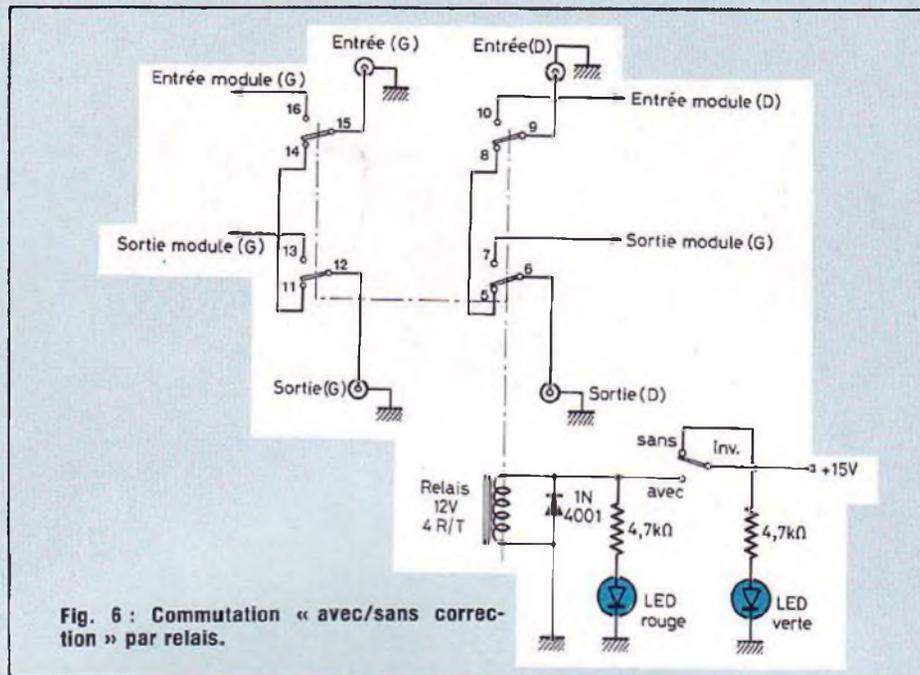
Fig. 6 : Commutation « avec/sans correction » par relais.
