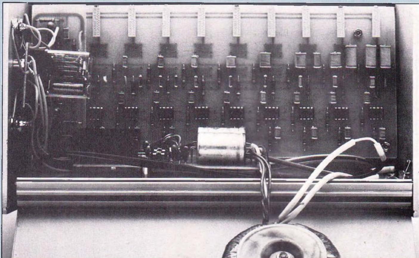
bande des fréquences des 20 Hz - 20 kHz, l'amplitude du signal de sortie doit rester pratiquement constante. La première voie du correcteur de fréquences est prête à intervenir dans la correction de l'acoustique du salon.
