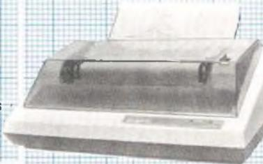
Imprimante graphique compacte - Interface parallèle en standard - 80 car./ligne - 30 car./sec. - Impression en simple ou double largeur - Papier normal - Entraînement par tracteurs ajustables - Interfaces TRS 80<sup>®</sup>, PET, RS 232, APPLE II disponibles.
