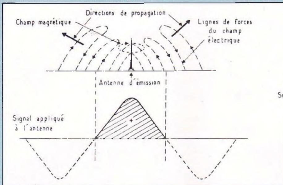
Fig. 6 : Les ondes rayonnées par une antenne sont constituées de deux « champs » : l'un électrique, l'autre magnétique, perpendiculaires et variant à la fréquence de la porteuse H.F.
