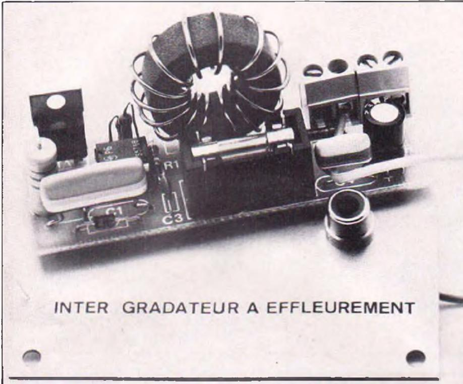
L'interrupteur gradateur à effleurement câblé et prêt à être introduit dans son coffret TEK0 P1.
