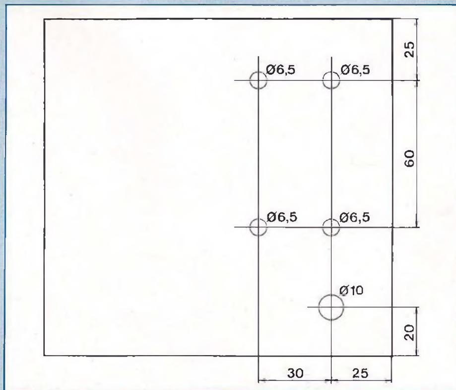
Fig. 16 : Plan de perçage de la face arrière.
