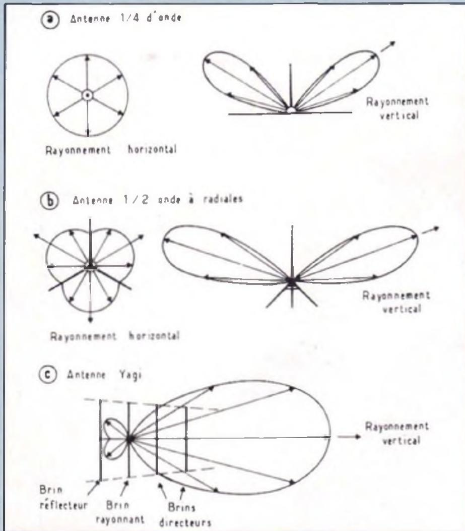
Fig. 10 : Diagrammes de rayonnement, horizontal et vertical, d'une antenne « quart d'onde » (a), d'une antenne « demi-onde » (b) et d'une antenne directive du type Yagi (c).
