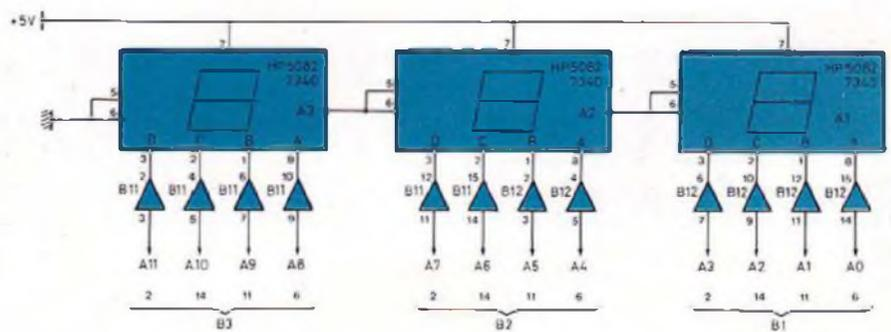
Schéma de principe du programmeur d'eprom 2716-2732.
