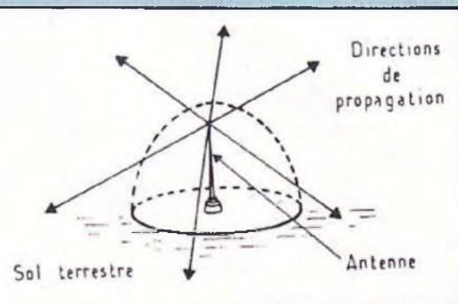
Fig. 7 : La propagation des ondes, à partir d'une antenne, s'effectue dans l'espace, de proche en proche, en délimitant un volume hémisphérique, en expansion croissante.
