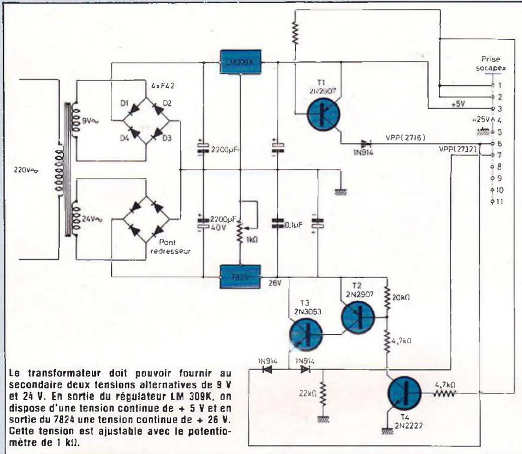
Le transformateur doit pouvoir fournir au secondaire deux tensions alternatives de 9 V et 24 V. En sortie du régulateur LM 309K, on dispose d'une tension continue de + 5 V et en sortie du 7824 une tension continue de + 26 V. Cette tension est ajustable avec le potentiomètre de 1 kΩ.
