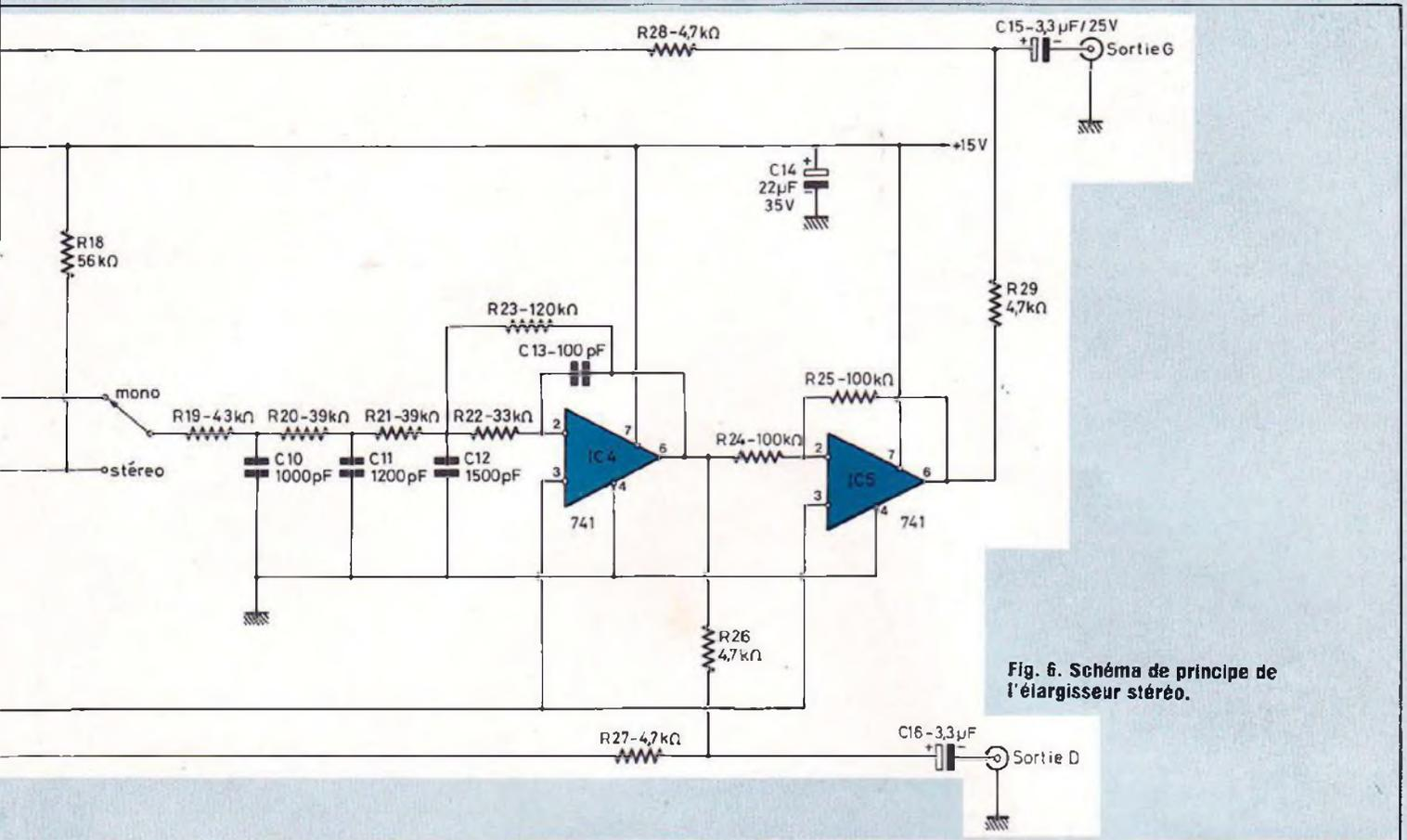
Fig. 6. Schéma de principe de l'élargisseur stéréo.
