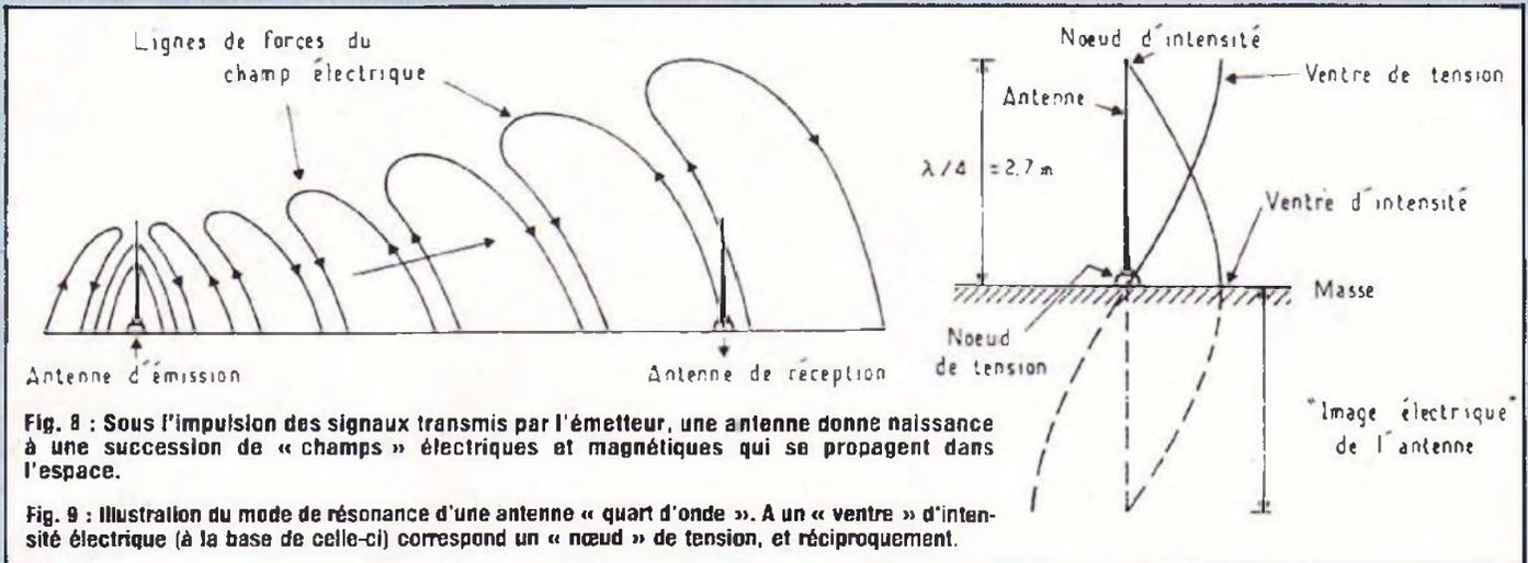
**Fig. 8 :** Sous l'impulsion des signaux transmis par l'émetteur, une antenne donne naissance à une succession de « champs » électriques et magnétiques qui se propagent dans l'espace.
