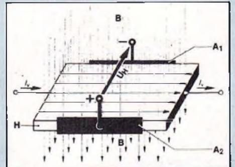
Fig. 3 : Production de la tension Hall  $U_H$ . H. Plaquette Hall -  $I_a$  Courant d'alimentation - A1 Surface de connexion négative - A2 Surface de connexion positive - B. Champ magnétique.
