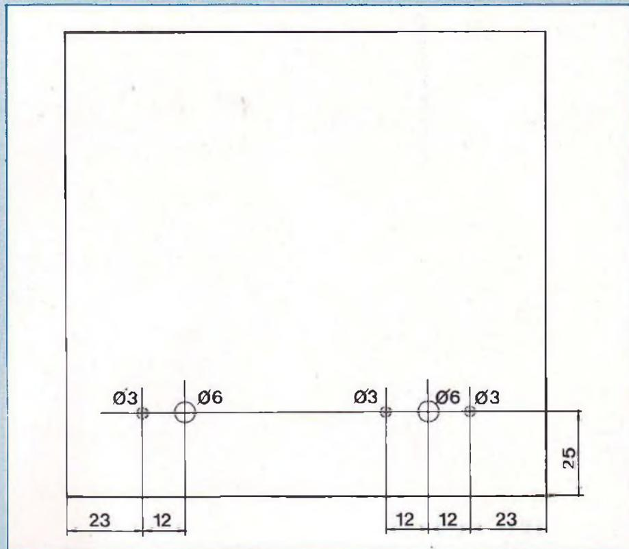
Fig. 15 : Plan de perçage de la face avant.
