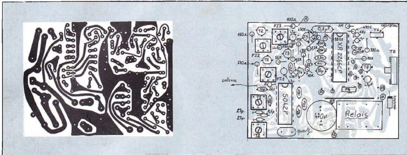
A gauche, circuit imprimé du récepteur-variateur R.V. 272. A droite, un plan de câblage précis malgré la densité des composants.
