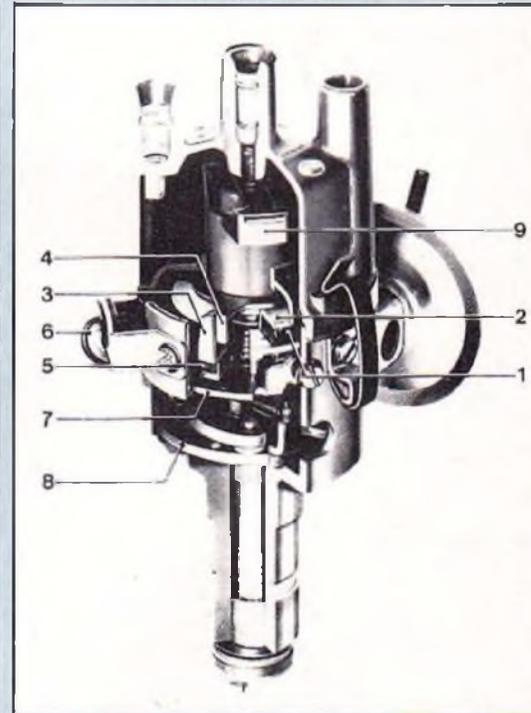
Fig. 1 : Allumeur avec générateur d'impulsions pour moteurs à 4 cylindres (boîtier sectionné).
