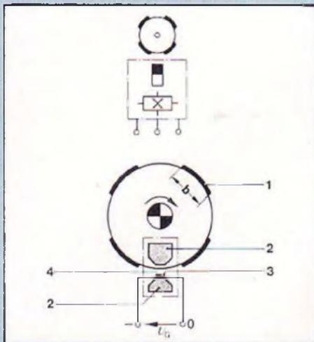
**Fig. 4 : Symboles graphiques et schéma de fonctionnement du générateur Hall.**
