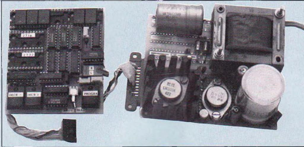
**C'**est un programmeur d'EPROM manuel. Cela a l'avantage de pouvoir « griller » des EPROM's sans passer par un système à microprocesseur ; il suffit de lui brancher un clavier HEXA sortant sur 8 bits.
