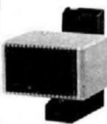
**RADAR HYPERFREQUENCE MW 21 IC**, 9,9 GHz. Portée de 3 à 30 m. Réglable. Intégration 1 à 3 pas réglable. Consommation 18 mA. Alimentation 12 V.
