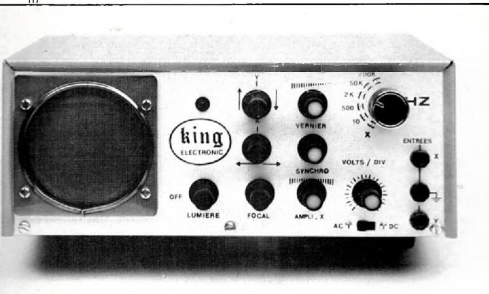
Cet oscilloscope est spécialement conçu pour la visualisation des signaux courants en électronique. Ses caractéristiques permettent un grand nombre de travaux dans le domaine des réalisations électroniques et dans la maintenance. Ce présent article a pour but de vous guider pas à pas dans toutes les étapes du montage, du câblage, de la mise au point de l'appareil. Tout a été mis en œuvre pour assurer une exposition claire et logique de la réalisation.
