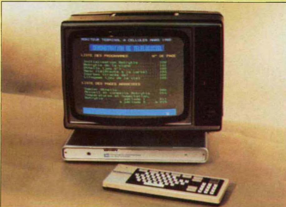
Terminal (expérimental) à téléchargement de logiciel en diffusion.
