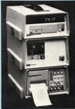
ainsi la portabilité requise dans les tests sur le terrain. Le cœur de chaque système est un thermomètre numérique de précision à 5 digits, utilisant un convertisseur analogique numérique double rampe.
