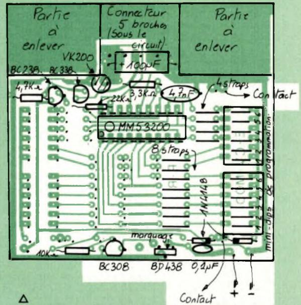
△ Plan de câblage du codeur EICP.
