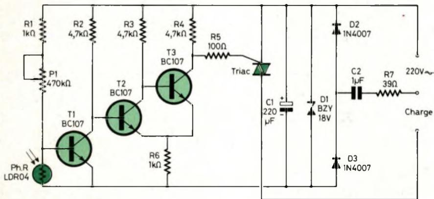
Le fonctionnement de l'appareil est basé sur les propriétés d'une cellule photo-électrique LDR dont la résistance varie proportionnellement à son éclairage.
