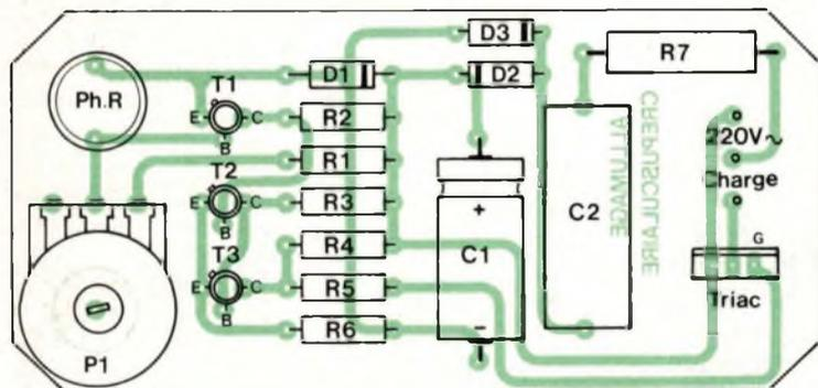
Veiller à bien respecter la polarité des diodes, au sens des transistors et du triac. La cellule LDR devra se trouver dans le coffret face au trou de  $\varnothing$  25 mm percé au dos.
