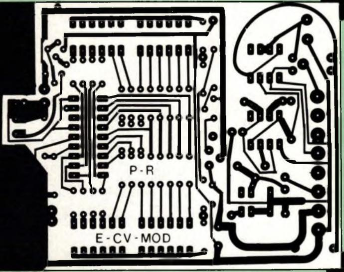
Les codeurs EICP et EICV font appel à un circuit simple face.
