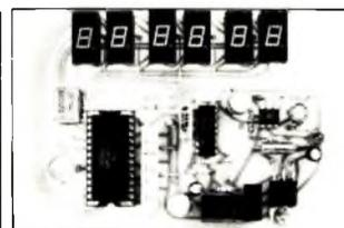
Elle fonctionnera sous une alimentation normale de 12 V fournie par la batterie du bord.
