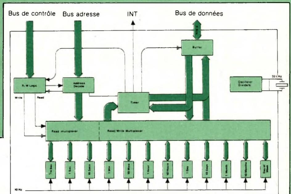
Fig. 7 : Schéma interne du MM 58174.
