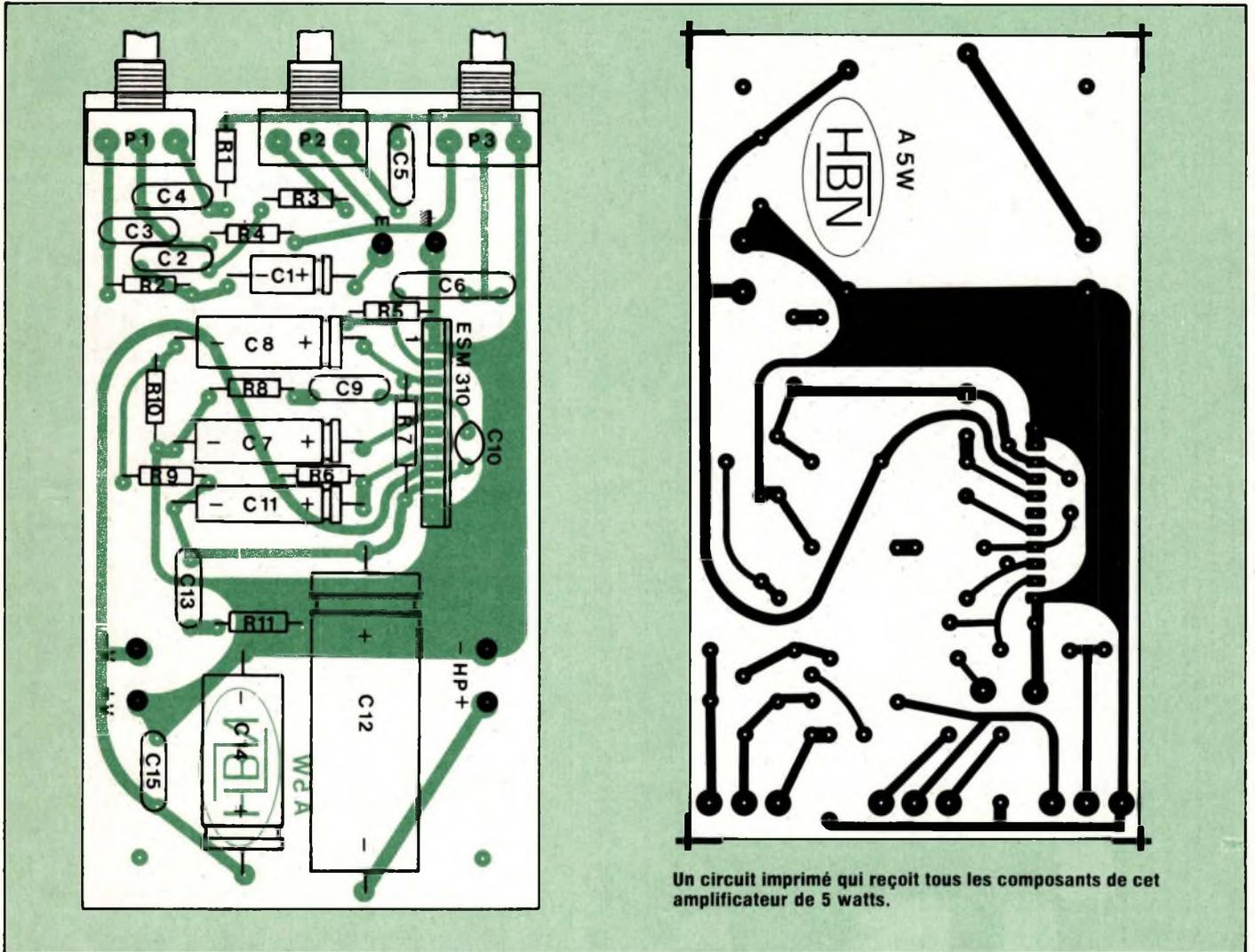
Un circuit imprimé qui reçoit tous les composants de cet amplificateur de 5 watts.
