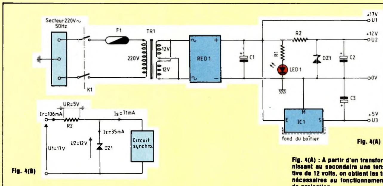
Fig. 4(A) : A partir d'un transformateur fournissant au secondaire une tension alternative de 12 volts, on obtient les trois tensions nécessaires au fonctionnement du central de projection.
