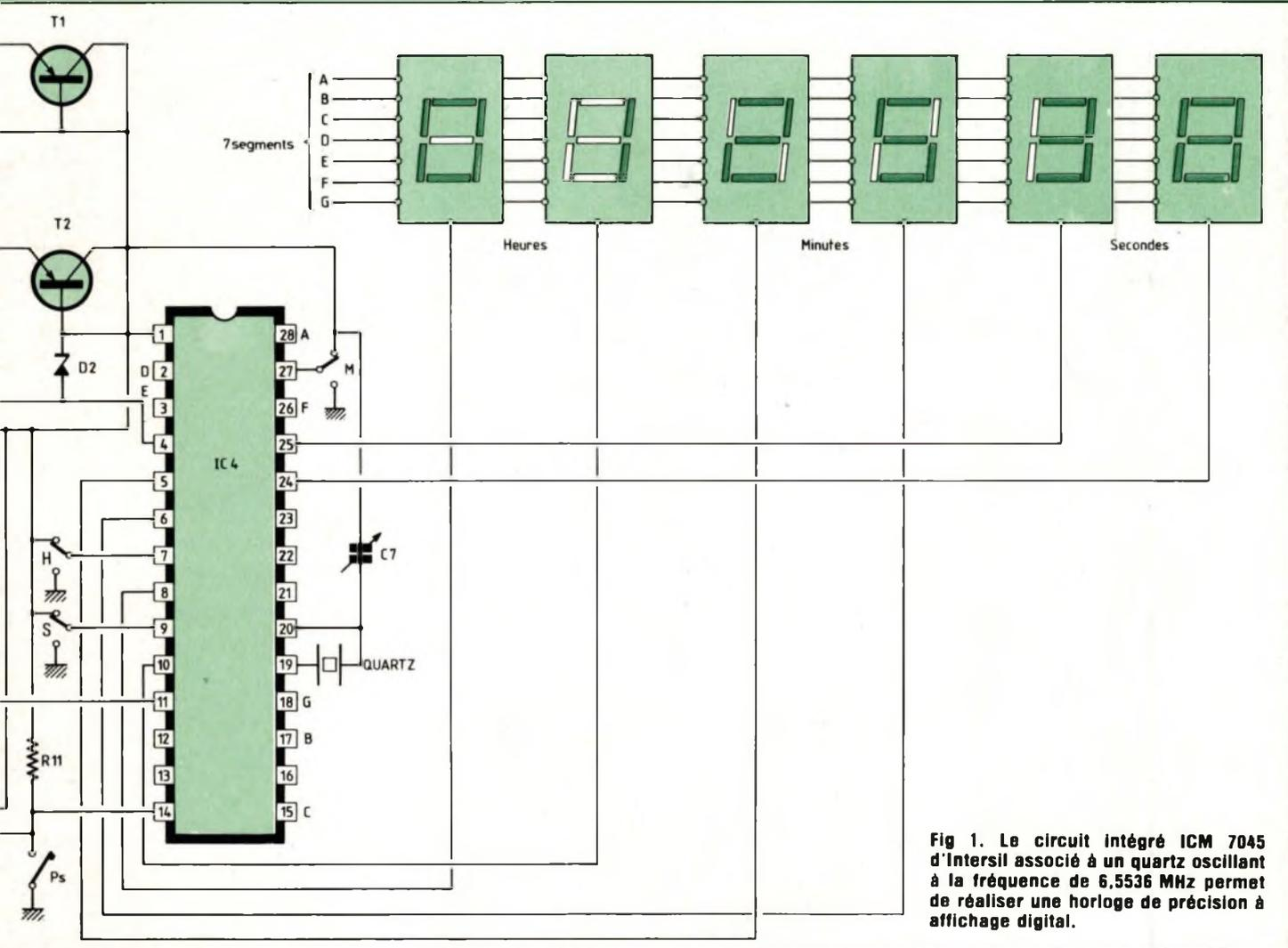
Fig 1. Le circuit intégré ICM 7045 d'Intersil associé à un quartz oscillant à la fréquence de 6,5536 MHz permet de réaliser une horloge de précision à affichage digital.
