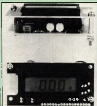
Cet indicateur de tableau digital LCD Multifonctions peut assurer la double fonction voltmètre et ampèremètre continu.
