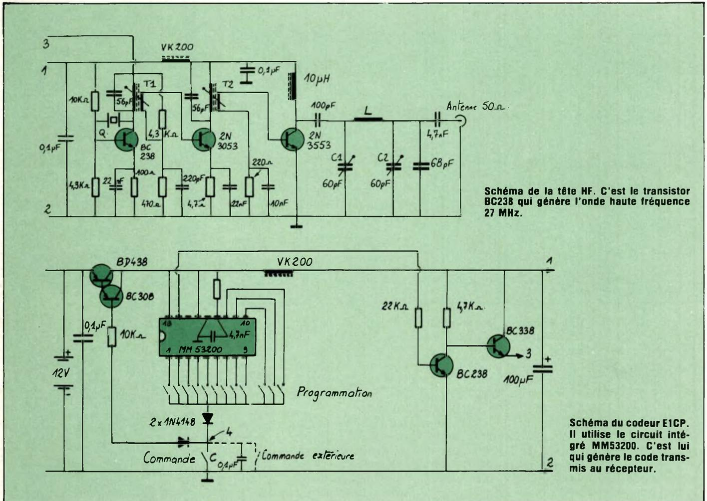
Schéma de la tête HF. C'est le transistor BC238 qui génère l'onde haute fréquence 27 MHz.
