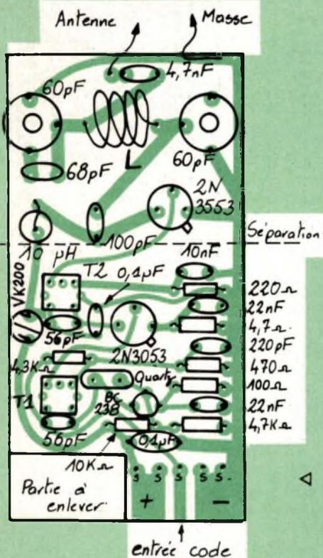
◁ Plan de câblage de la tête HF. L'ensemble est ensuite logé dans un boîtier de blindage. Ne pas oublier de souder la plaque de séparation.
