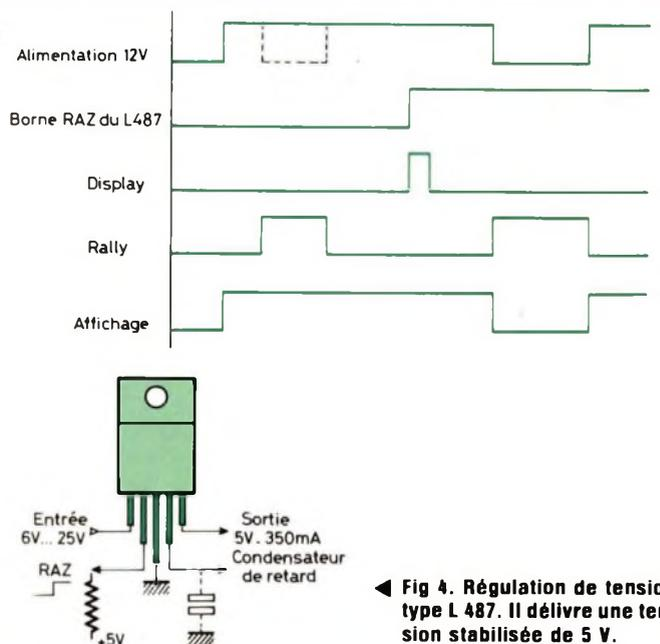
Fig 4. Régulation de tension type L 487. Il délivre une tension stabilisée de 5 V.
