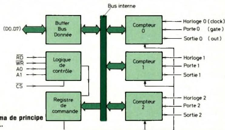
Fig. 2 : Schéma de principe du 8253 INTEL.
