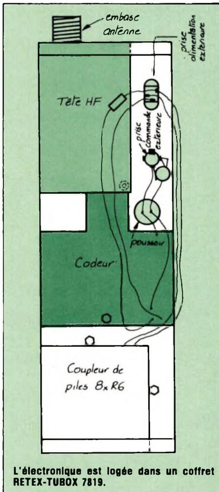
L'électronique est logée dans un coffret RETEX-TUBOX 7819.
