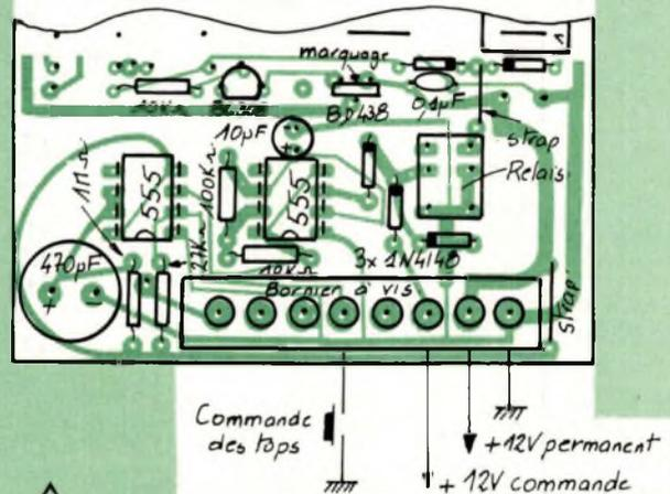
△ Plan de câblage du codeur EICV (partie inférieure, la partie supérieure étant identique à celle du codeur EICP).
