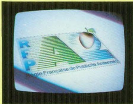
Fig. 2A : Obturateur focal, à déplacement horizontal, réglé au  $1/60^{\circ}$  s. On distingue deux barres obliques.
