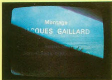
Fig. 1B : Rectangle foncé obtenu avec un obturateur focal, à déplacement vertical, réglé au 1/125<sup>e</sup> s.
