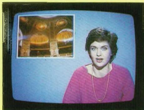
Fig. 5 : Obturateur focal, à déplacement vertical, réglé au 1/15° s. Noter l'absence de tout rectangle foncé.
