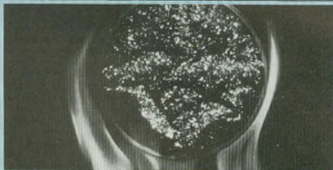
Le système coupe-feu 3M «Fire Barrier» est constitué d'une gamme de produits flexibles et intumescents qui empêchent la propagation de l'incendie et de ses effets directs (flammes, fumées, gaz toxiques et corrosifs) en obturant les ouvertures dans les cloisons et planchers, et en protégeant les surfaces vulnérables. Il restaure l'intégrité coupe-feu des planchers et des cloisons.
