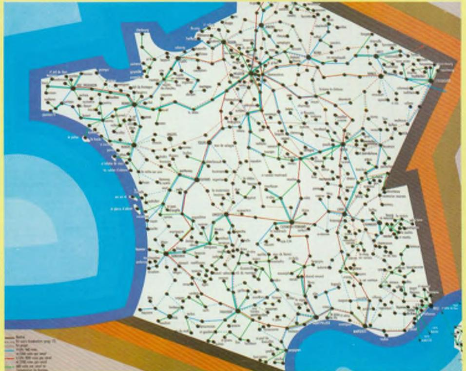
Fig. 7. Une liaison hertzienne est composée de réémetteurs espacés au maximum tous les 50 km.
