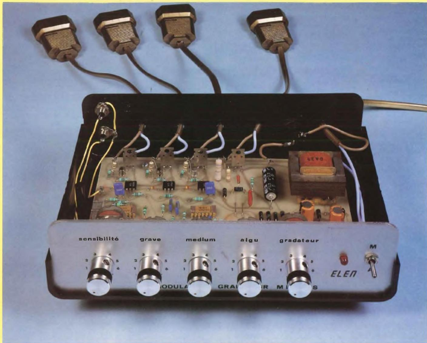
Un deuxième boîtier LM 324 fournit trois des quatre ampli-op qu'il contient pour l'élaboration des trois filtres actifs. Le premier de ces filtres, du type passe-bas à source contrôlée apporte une atténuation de 12 dB par octave à partir de sa fréquence de coupure qui a pour valeur :
