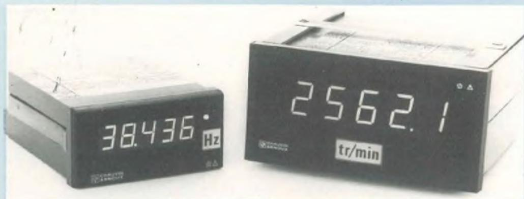
40 000 points d'affichage. La précision est de  $10^{-4}$  à  $6,10^{-4}$  selon le facteur d'échelle. Afin de pouvoir introduire l'appareil dans une chaîne de mesure, des cartes additionnelles incorporées permettent de disposer
