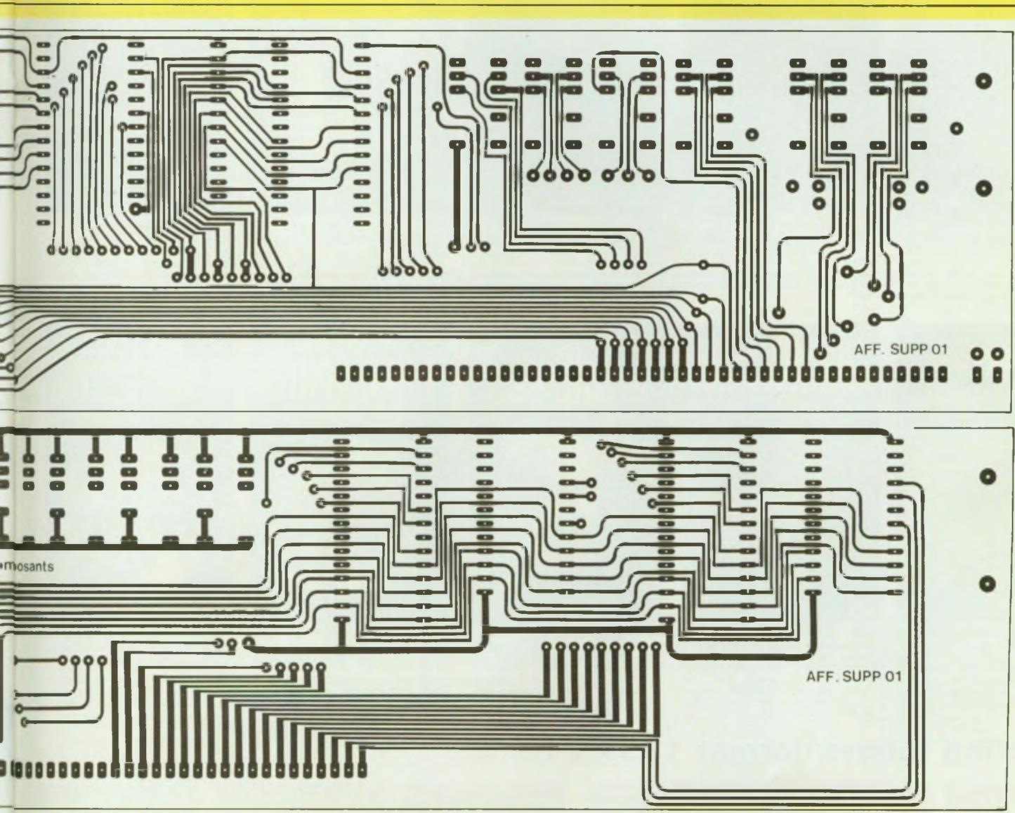
Fig. 12 : Implantation du circuit imprimé double face de la carte -affichage et supports d'Eproms-.
