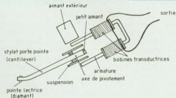
Fig. 2 : Cellule à aimant induit. Principe.
