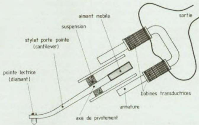
Fig. 1 : Cellule à aimant mobile. Principe. L'aimant est solidaire de l'équipage mobile.
