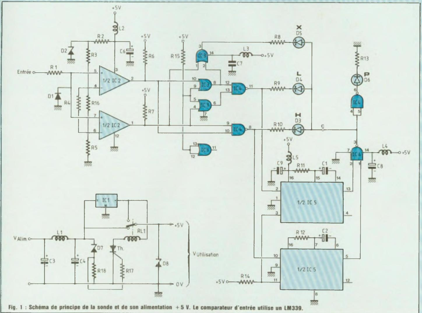
Fig. 1 : Schéma de principe de la sonde et de son alimentation + 5 V. Le comparateur d'entrée utilise un LM339.
