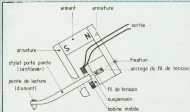
Fig. 3 : Cellule à bobine mobile. Principe.
