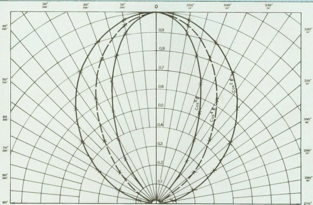
Fig. 6 : Modèle mathématique du facteur d'illumination  $\lambda(\phi)$  (diagramme de rayonnement théorique).
