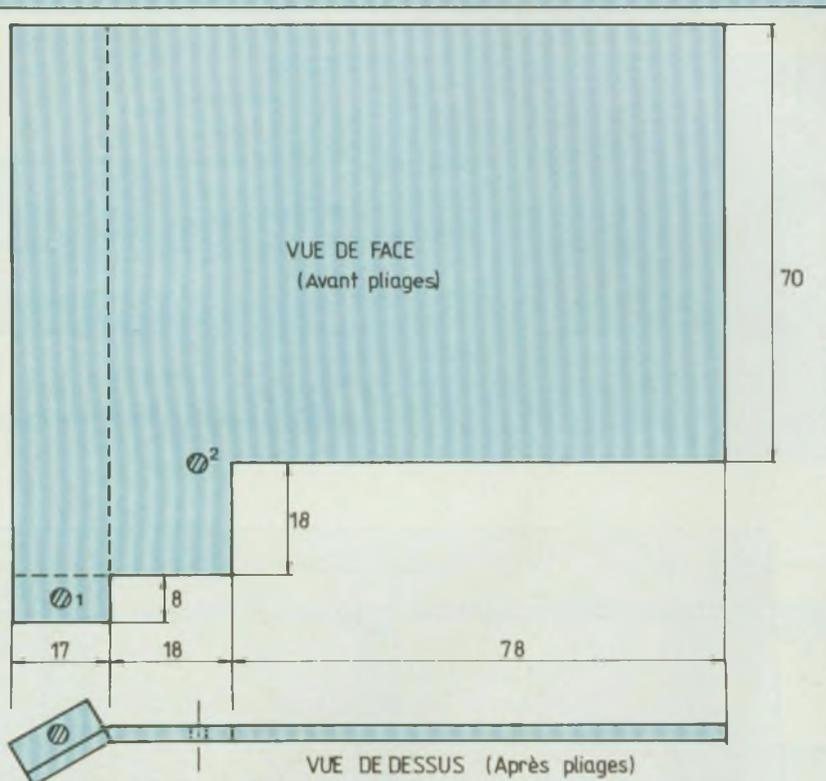
Fig. 23 : Refroidisseur de IC10 réalisé dans de l'aluminium.
