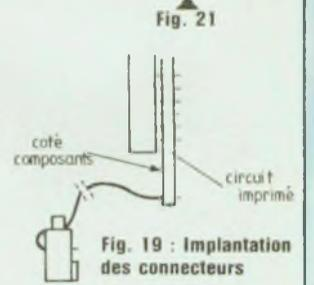
Fig. 19 : Implantation des connecteurs
