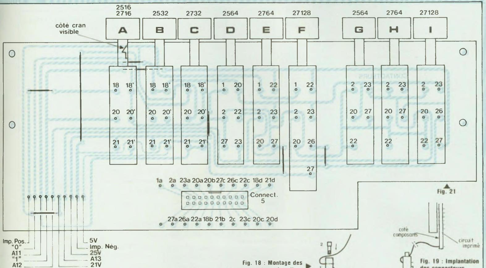
Fig. 18 : Montage des connecteurs femelles
