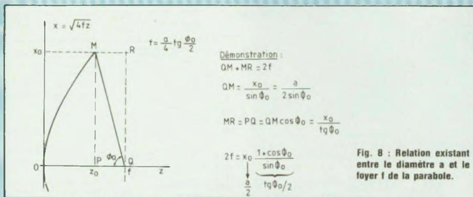
Là,  $\phi_0$  intervient et si nous retenons les conseils qui découlent de la figure 7, nous prendrons  $\phi_0 = 52^\circ$  pour avoir un gain maximal, avec une illumination de degré  $n = 4$ .
