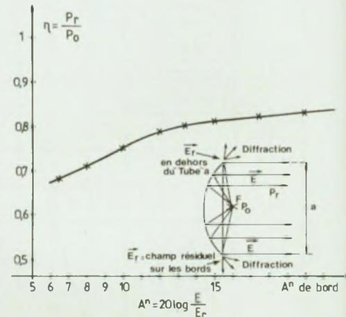
Fig. 5 : Courbe du rendement d'une parabole perturbée par les effets de bordure.
