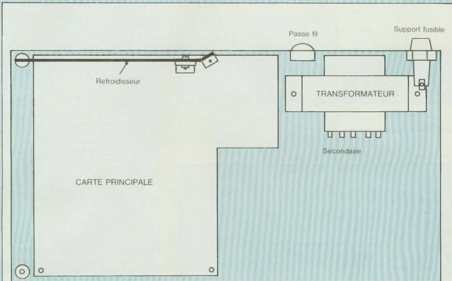
Fig. 29 : Implantation des éléments dans le coffret.
