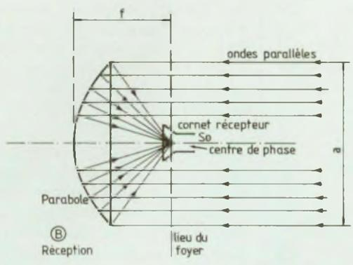
Fig. 4 : Concentration du champ en un canal de diamètre a.
