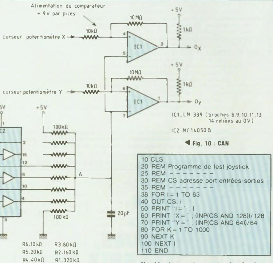
Fig. 11 : Lecture des coordonnées  $O_x$ ,  $O_y$  du joystick.
