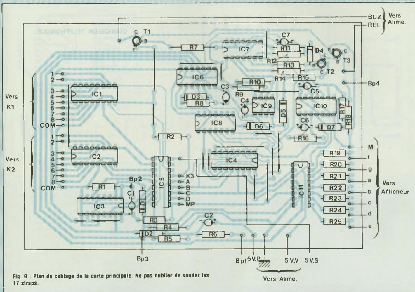
Fig. 9 : Plan de câblage de la carte principale. Ne pas oublier de souder les 17 straps.
