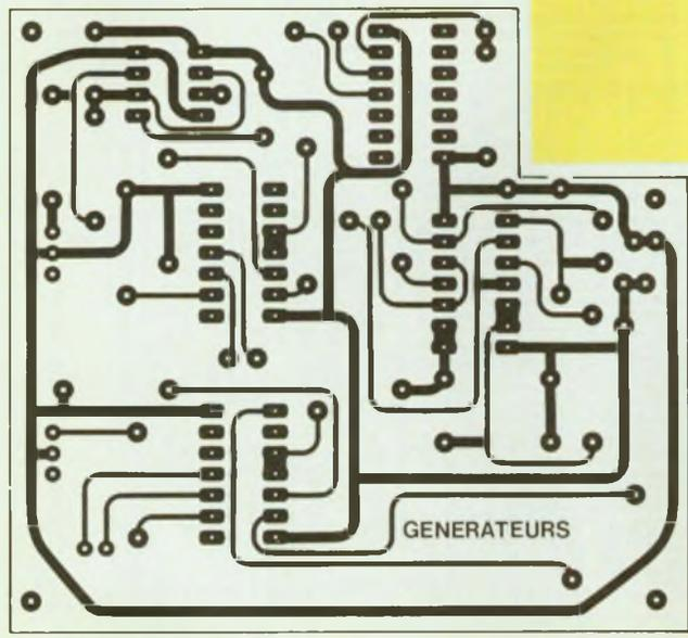
Fig. 11 : Tracé de la carte -générateur d'impulsions-.
