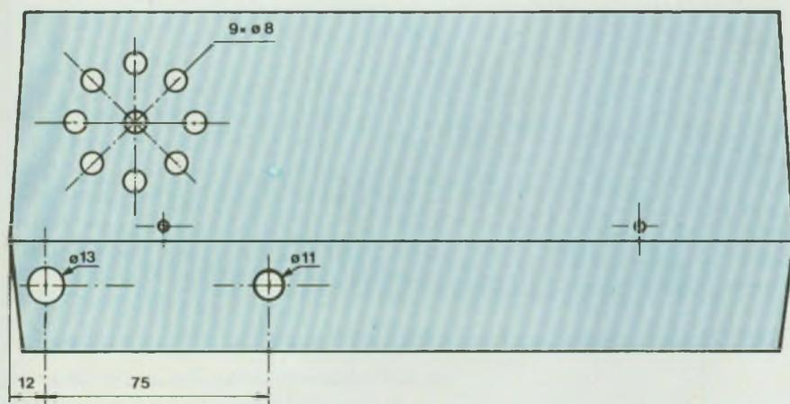
Fig. 28 : Perçage de la partie arrière du coffret.
