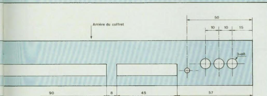
Fig. 27 : Perçage de la partie supérieure du coffret.
