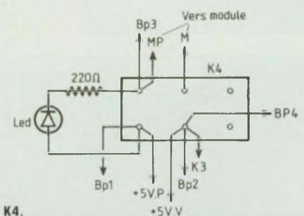
Fig. 12 : Interconnexions des prises mâle et femelle du téléphone ainsi que celles du commutateur K4.
