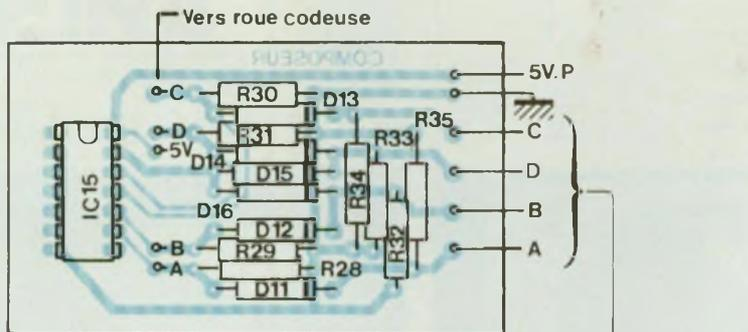
Module à raccorder à la roue codeuse et au circuit principal.
