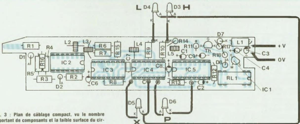
Fig. 3 : Plan de câblage compact, vu le nombre important de composants et la faible surface du circuit imprimé.
