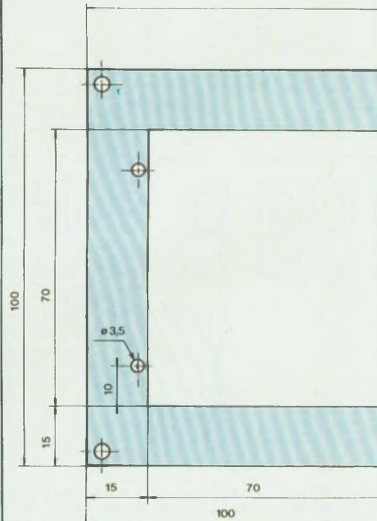
Fig. 24 : Plan de perçages de la face avant 'basse'.
