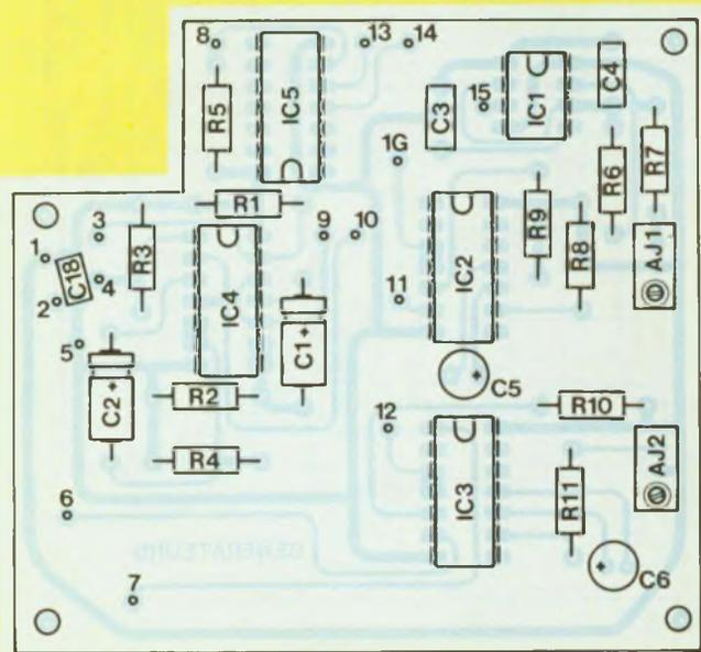
Fig. 18 : Implantation des composants de la carte -générateur d'impulsions-.
