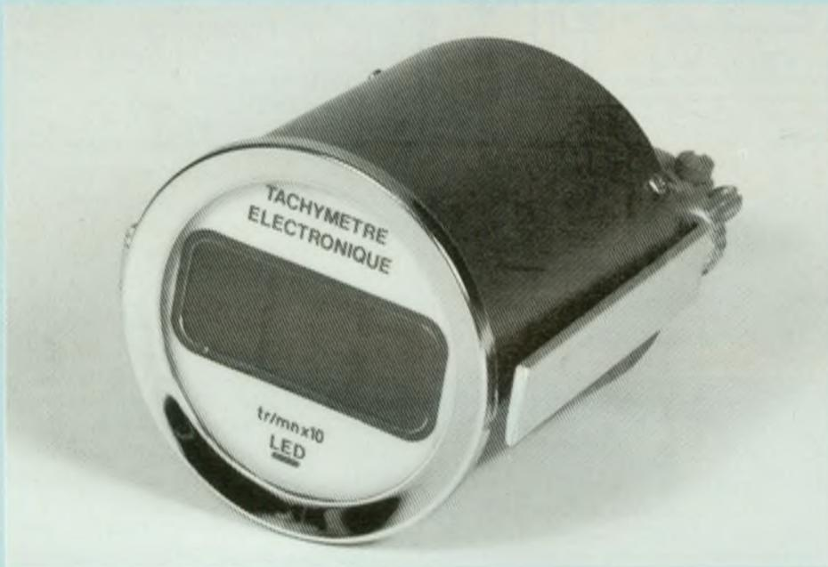
De tels appareils existent dans le commerce spécialisé. Généralement pour moteurs à carburateur quatre cylindres, quatre temps, ils permettent une lecture du nombre de tours/moteurs sur deux afficheurs, soit une résolution de  $\pm 100$  tr/mn. De plus, afin de parfaire l'équipement du tableau de bord, ils sont proposés en petit boîtier à glace frontale et enjoliveur chromé.
