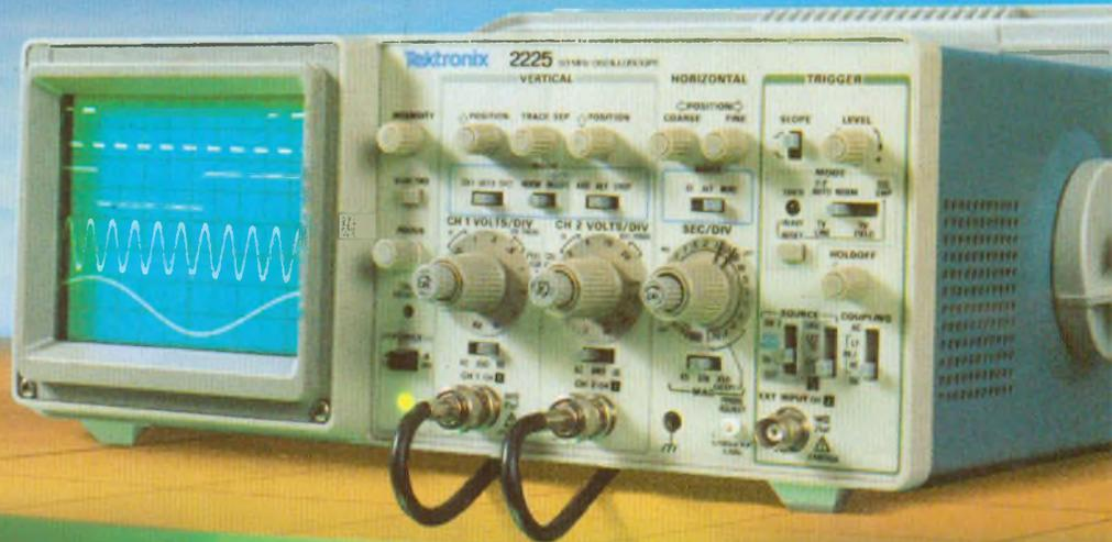
Dominer sa technologie pour Tektronix c'est être capable, à la fois, d'améliorer ses performances et de baisser ses prix. L'oscilloscope portable Tektronix 2225 en est la preuve : bande passante de 50 MHz ; sensibilité de 500  $\mu$ V pour la mesure des signaux faibles ; balayage alterné pour une analyse détaillée ; système de déclenchement complet et automatique ; plus la simplicité d'utilisation et la fiabilité Tektronix, le tout pour **7500 Francs \***
