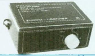
A réaliser soi-même à partir d'une lampe à ultra-violet germicide TUV 6 W de Philips avec douille, se branche directement sur le secteur 220 V, rayonnement dans la bande des 25-37 Å. La lampe reste allumée uniquement pendant l'effacement de l'EPROM mais pas plus longtemps. **Kit. 458 F**
