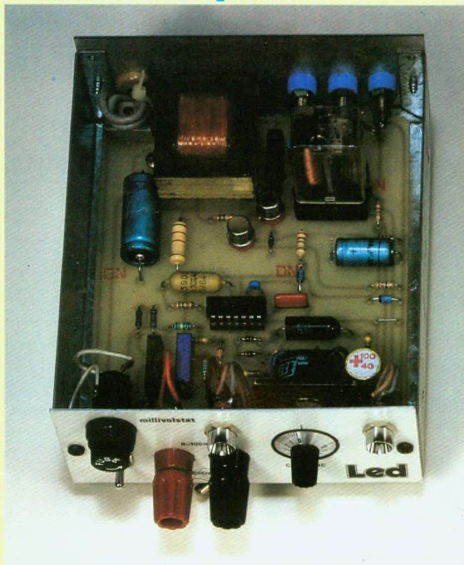
Led n° 46 nous a permis de présenter cet appareil de précision capable de consigner à l'avance une tension directe de 0 à 100 continu à  $\pm 1$  mV. Après avoir expliqué le fonctionnement de la partie mesure de cette électronique, basée sur un pont de Wheaststone sophistiqué, nous abordons l'alimentation de notre millivolstat.
