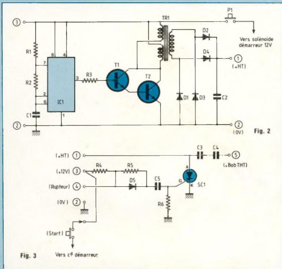
Sur la broche 3 de IC1, nous obtenons donc des créneaux d'amplitude égale à la tension d'alimentation, la sortie étant à vide.
