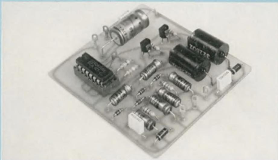
Sous la forme d'une petite carte imprimée de faibles dimensions, 70 mm x 65 mm, la réalisation proposée permet, alimentée sous une tension continue de 12 V, de bénéficier à la sortie d'une tension symétrique de ±24 V avec une unique référence de tension entre l'entrée et la sortie. Ce petit montage est intéressant puisqu'il permet d'obtenir, à peu de frais, sous un faible volume et à l'aide de composants très courants, une tension de sortie symétrique double de celle d'entrée.
