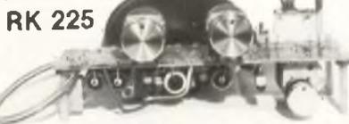
Couvre de 70 à 200 MHz par selfs interchangeables très faciles à réaliser, sensibilité élevée (1 µV). Stabilité parfaite, montage à 2 transistors et 1 circuit intégré, recherche des stations par varicap, circuit imprimé fourni, livret très détaillé.
