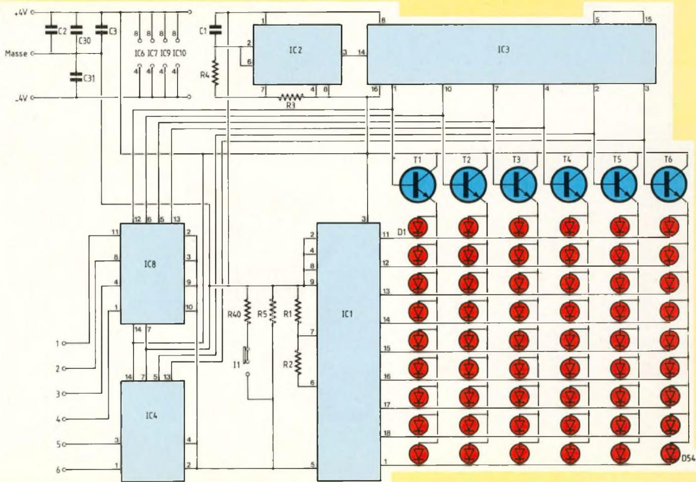
Fig. 3(b) : Schéma électrique de la partie numérique de l'analyseur.
