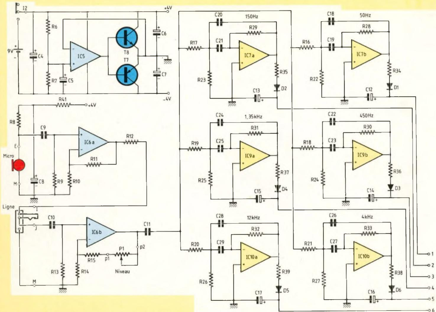
Fig. 3(a) : Schéma électrique de la partie analogique.
