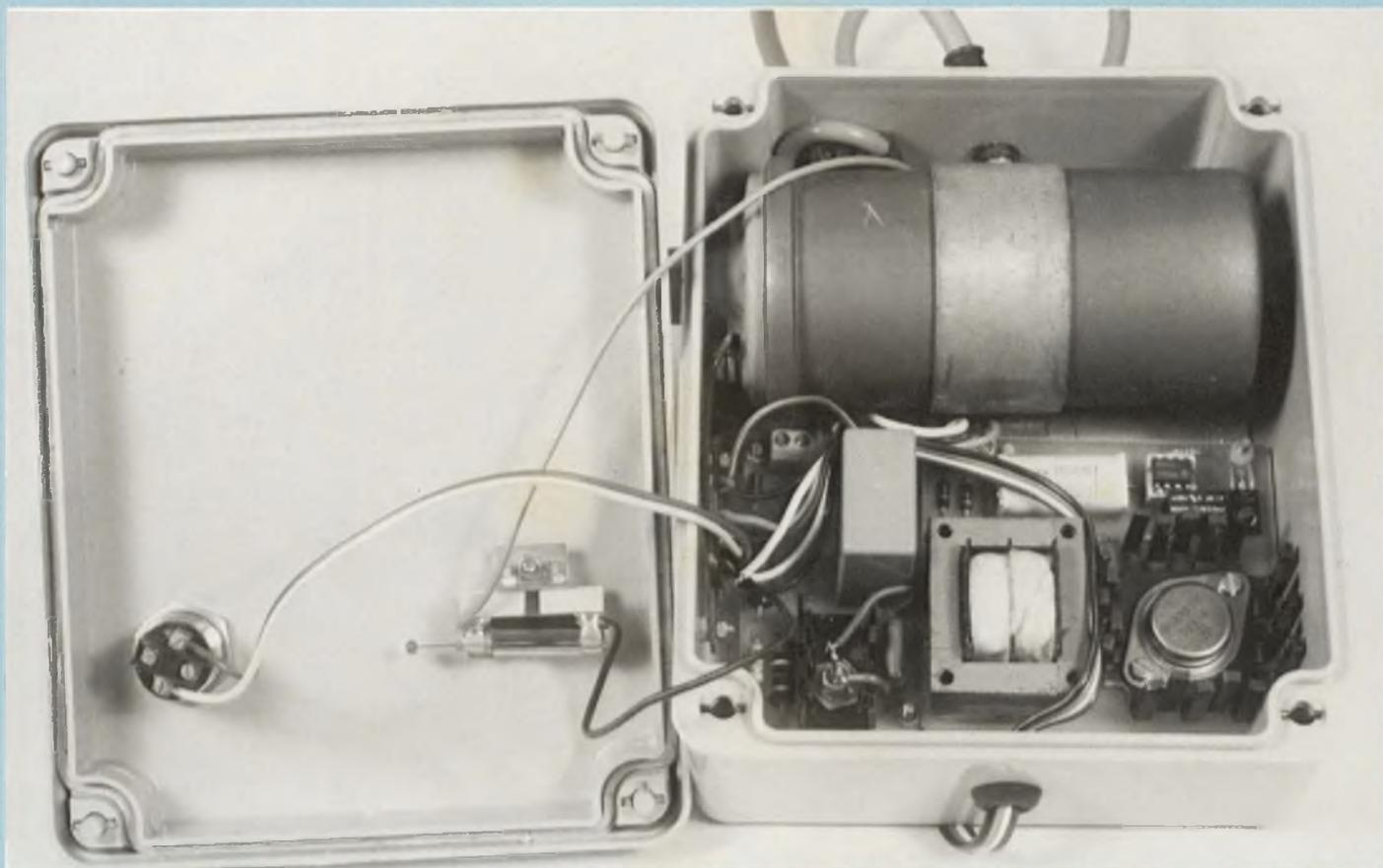
Afin de pouvoir le remplacer par un modèle équivalent, nous donnons dans le petit tableau ci-après les caractéristiques principales de ce transistor que l'on peut se procurer aussi avec les indices A ou TH. Au secondaire de TR1, la tension alternative de sortie a une amplitude d'environ 300 à 350 V avec une légère dissymétrie en ce qui concerne l'alternance négative.
