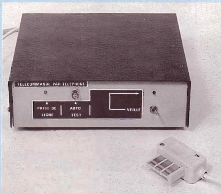
L'appareil décrit commande à distance, sur une ligne téléphonique bifilaire tout dispositif électrique en tout ou rien : allumage et extinction.
