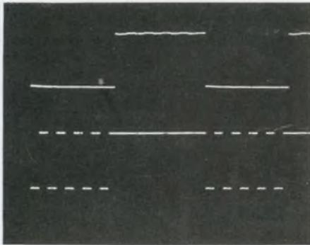
Fig. 4 : Le circuit OU fonctionne en porte : il laisse passer, ou arrête, les signaux de l'entrée E2, selon l'état logique imposé à E1.
