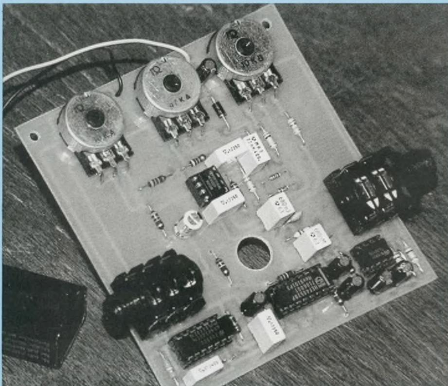
L'OVERDRIVE génère un son qui n'est pas sans rappeler la saturation progressive délivrée par les amplificateurs à lampes. L'effet est donc différent de l'écrêtage qui est obtenu avec les pédales de distorsion classiques, ou encore de la saturation brute et massive des pédales du genre "Heavy-métal". Un réglage de tonalité garantit une saturation homogène à toutes les fréquences et un son riche en harmoniques.
