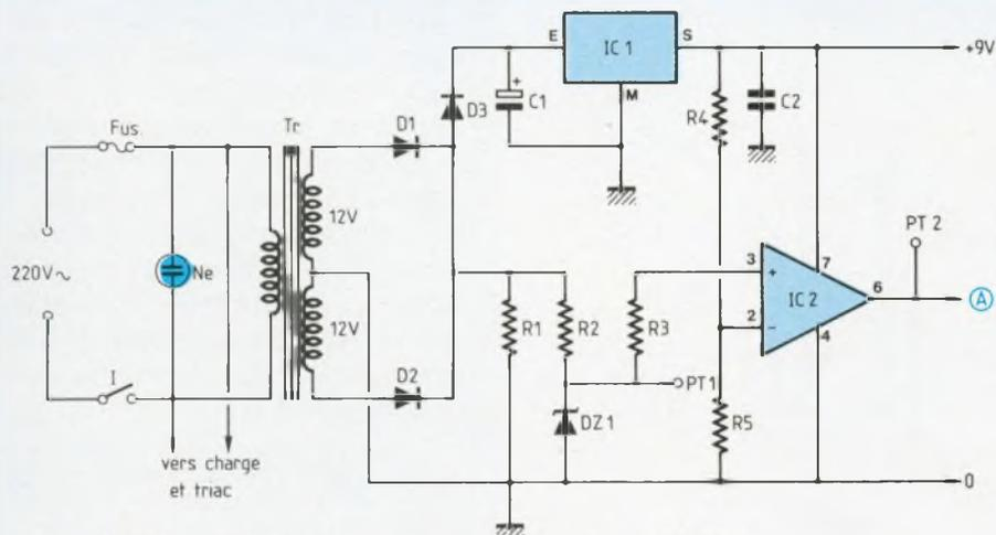
Fig. 5 : Dispositif de redressement qui exploite trois diodes.
