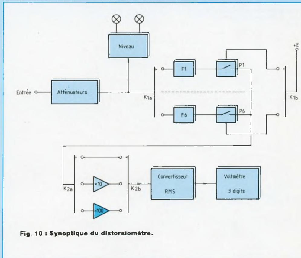
Fig. 10 : Synoptique du distorsiomètre.
