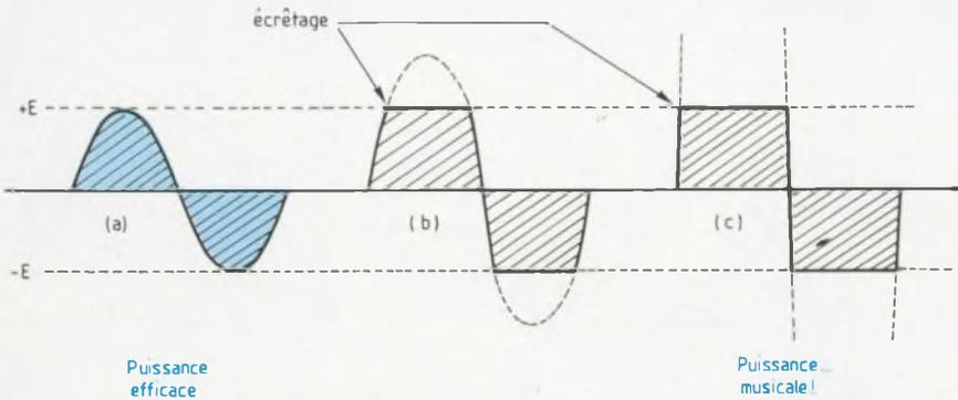
**Fig. 3 :** La puissance délivrée à la charge est proportionnelle à la surface délimitée par la courbe, sur une période. Elle croît lorsqu'il y a écrêtage.
