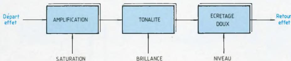
Fig. 4 : Schéma fonctionnel de la pédale Overdrive.
