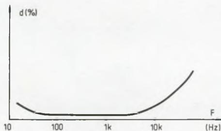
Fig. 9 : Evolution de la distorsion harmonique avec la fréquence.
