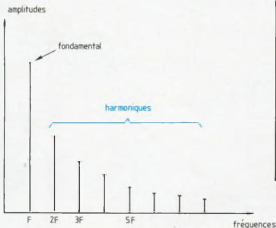
Fig. 1 : Décomposition spectrale d'un signal complexe.
