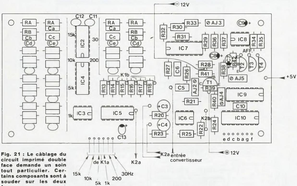
**Fig. 21 :** Le câblage du circuit imprimé double face demande un soin tout particulier. Certains composants sont à souder sur les deux faces.
