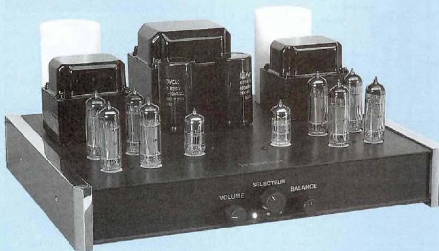
**C**ette modification nous la devons à l'OCTUOR classe A. Mécontent des résultats d'écoutes obtenus en prélevant le signal de commande des grilles des EL84 sur l'anode de la triode montée en étage déphaseur, nous avons eu l'idée lors de nos nombreux essais de prélever celui-ci sur la cathode. Notre configuration de base d'étage déphaseur adoptée pour un fonctionnement de notre schéma également en push-pull permettait en effet de disposer de deux signaux identiques mais en
