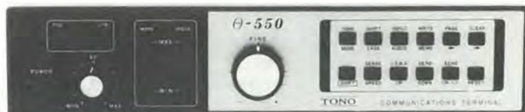
**theta-550 — TONO** — Décodeur de signaux morse, RTTY et ASCII. Se branche derrière un récepteur ondes courtes. Lecture sur téléviseur (entrée antenne), moniteur vidéo ou imprimante. Possibilité de mise en route et d'arrêt automatique par un code programmable. VU-mètre linéaire à diodes LED. 2 mémoires de 640 caractères. 4 mémoires de 23 caractères. Permet également l'apprentissage du morse.
