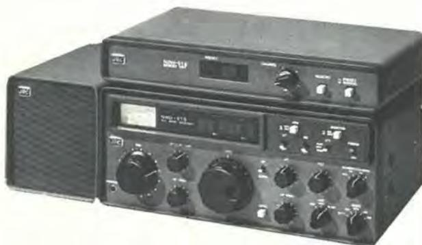
**ND 515 — JRC** — Récepteur semi-professionnel entièrement synthétisé, couvre de 100 kHz à 30 MHz en 30 gammes. Affichage digital de la fréquence. Modes AM/SSB/CW/RTTY. Sélectivité commutable et réglable: 6 kHz - 2,4 kHz. En option: 600 Hz - 300 Hz.
