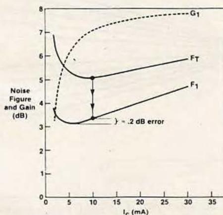
Lorsqu'on fait varier l'impédance de la source et le courant de polarisation d'un transistor, pour trouver le facteur de bruit minimal, le gain varie également. Par conséquent, si  $F_T$ , le facteur de bruit global, est mesuré au cours de l'accord, son minimum sera affecté par la manière dont le gain  $G_1$  aide à maîtriser le bruit de second étage. Le minimum  $F_T$  sera donc une combinaison du minimum de  $F_1$  et du maximum de  $G_1$ , la proportion exacte dépendant de  $F_2$ .
