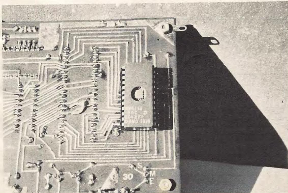
PROGEPROM VU COTE CUIVRE: la modification du circuit imprimé à gauche de la 2716 qui existe sur cet exemplaire a été rectifiée. Le mylard joint compte de cette modification.
