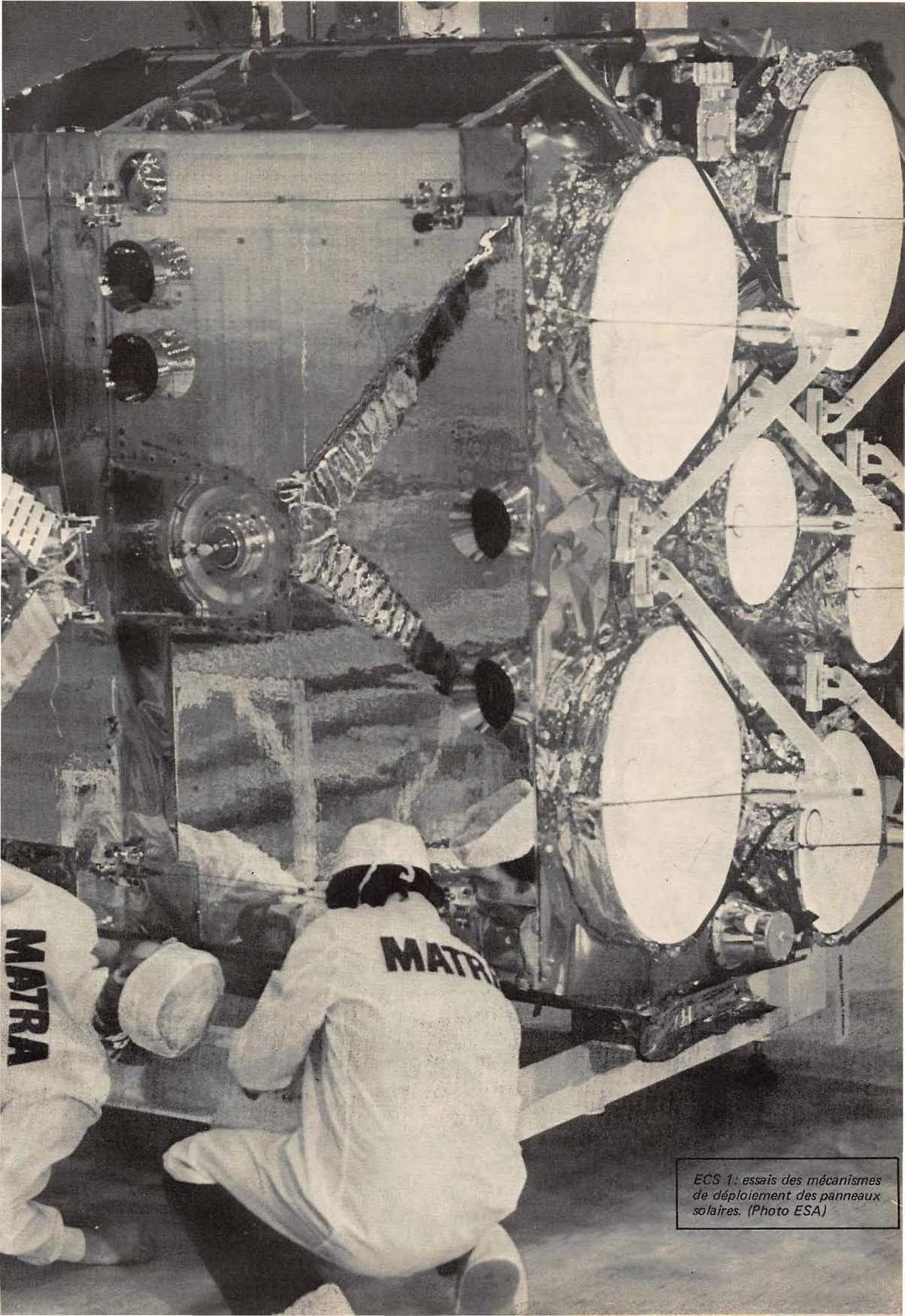
*ECS 1: essais des mécanismes de déploiement des panneaux solaires. (Photo ESA)*
