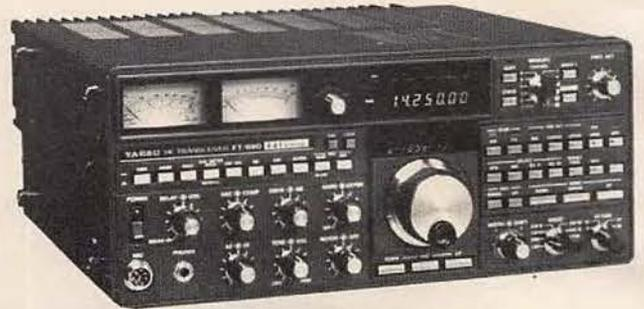
**FT 980** Récepteur 150 kHz à 30 MHz. Emetteur bandes amateurs. Tous modes AM/FM/BLU/CW/FSK, 120 W HF, tout transistor, alimentation secteur. **CAT SYSTEM:** interface de télécommande par ordinateur (en option).
