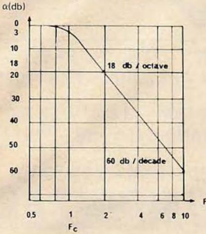
Un émetteur est constitué d'un transistor de sortie ayant une pente de 6 dB/octave. Il comporte un circuit accordé série suivi d'un filtre en pi passe-bas. Déterminer l'atténuation pour l'harmonique 3.
