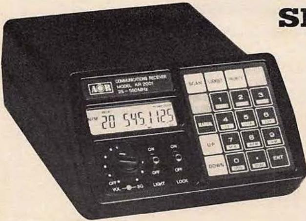
**AR 2001 — AOR** — Récepteur scanner couvrant de 25 MHz à 550 MHz sans trou, par pas de 5 kHz, 12,5 kHz et 25 kHz, NBFM/WBFM/AM, 8 mémoires, alimentation 12 à 14 V DC, dimensions: L 138 x H 80 x P 200 mm, poids: 1,1 kg.
