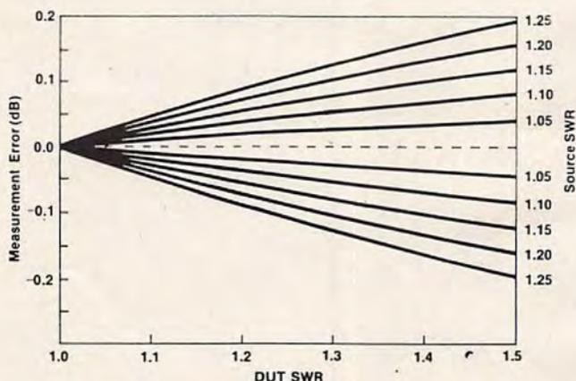
L'une des erreurs les plus importantes est due à la désadaptation source de bruit. Ceci a pour effet de modifier l'ENR. En outre, l'impédance de sortie de la source de bruit diffère selon qu'elle est à l'arrêt ou en marche. Par conséquent, la variation de  $T_H$  diffère de celle de  $T_c$ .
