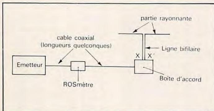
La ligne bifilaire ne doit pas courir à l'intérieur d'un appartement ; la boîte d'accord sera donc située soit à l'extérieur soit juste à l'endroit où pénètre la ligne. Cette dernière solution présente l'avantage d'un accès facile à la boîte, d'où des changements de fréquences ou de bandes plus aisés. La ligne reliant l'émetteur à la boîte est réalisée en câble coaxial  $50$  ou  $75\Omega$  ; elle
