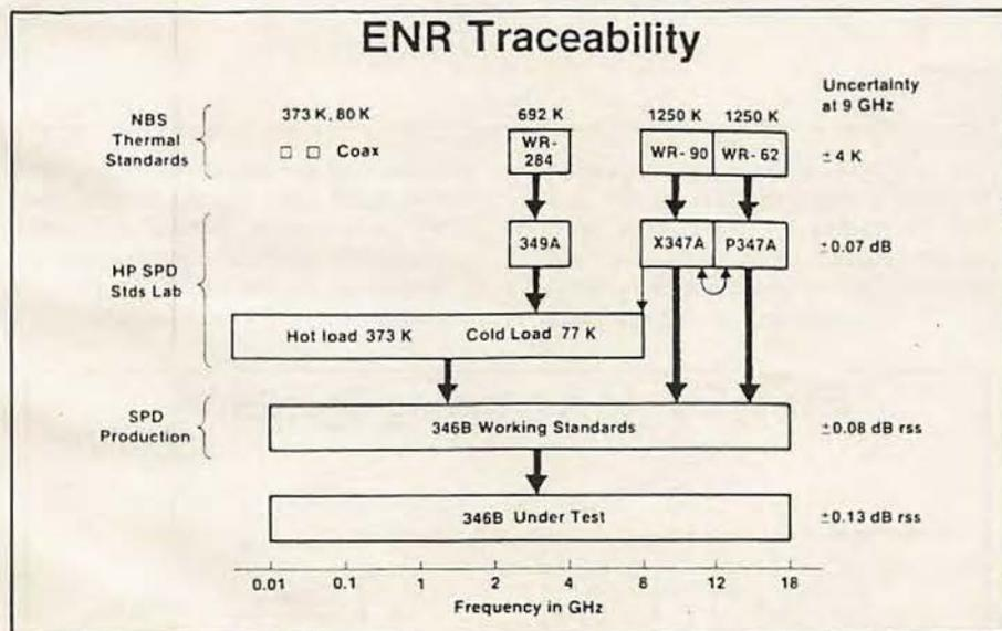
L'utilisation d'un ENR correct présente deux facettes dont la première consiste à assurer une grande précision en ce qui concerne les points individuels d'étalonnage. Les sources de bruit à l'état solide n'étant pas des normes fondamentales, il est nécessaire de les étalonner en se servant d'une norme fondamentale, à savoir une résistance physiquement chauffée. Le Bureau National de Normalisation des États-Unis (United States National Bureau of
