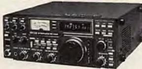
**IC 751** : transceiver à couverture générale de 2<sup>e</sup> génération. Tous modes. 32 mémoires. 2 VFO'S. Réception, 4 changements de fréquences. Possibilité d'alim. 220 V incorporée. Livré complet, prêt à fonctionner, micro compris.
