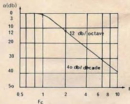
Filtre en pi passe-bas à 3 éléments ( $C_1$ ,  $C_2$  et L)
