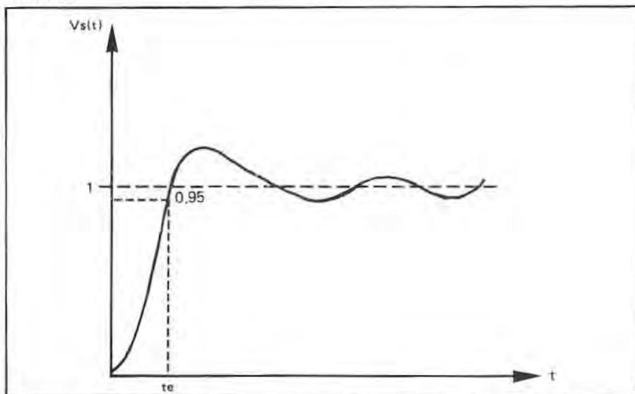
FIGURE 3 : Définition du temps d'établissement à -5%.
