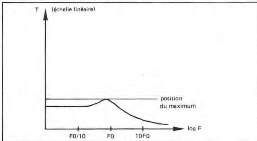
FIGURE 4 : Courbe du temps de propagation de groupe.
