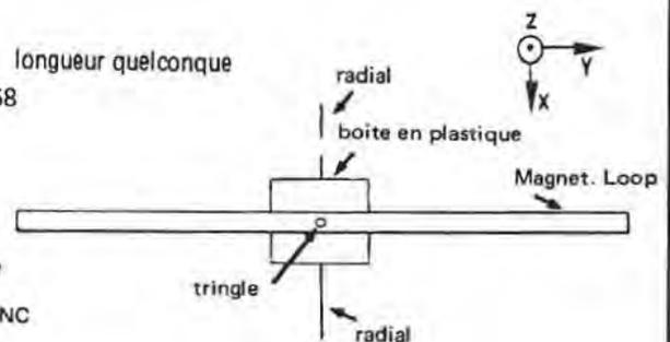
Fig. 15 b.2.3. Symétriseur et adaptateur pour EMBA 2 m à couplage capacitif
