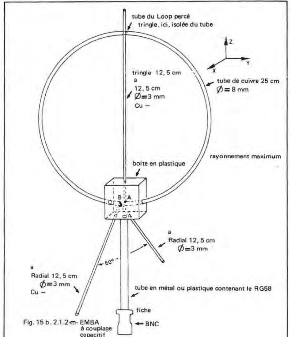
Fig. 15 b. 2.1.2-m-EMBA à couplage capacitif
