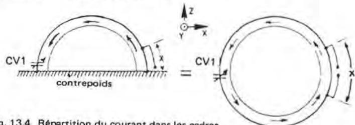
Fig. 13.4 Répartition du courant dans les cadres
