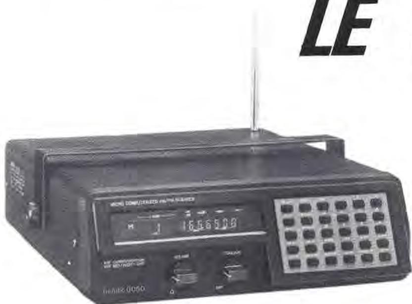
Le scanner HANDIC 0050 appartient à la troisième génération de récepteurs VHF-UHF à balayage de fréquence automatique. Il est le successeur des modèles 0012 et 0016 de la marque. Sa gestion par microprocesseur ainsi que l'étendue des gammes couvertes en font le plus performant de la gamme.
