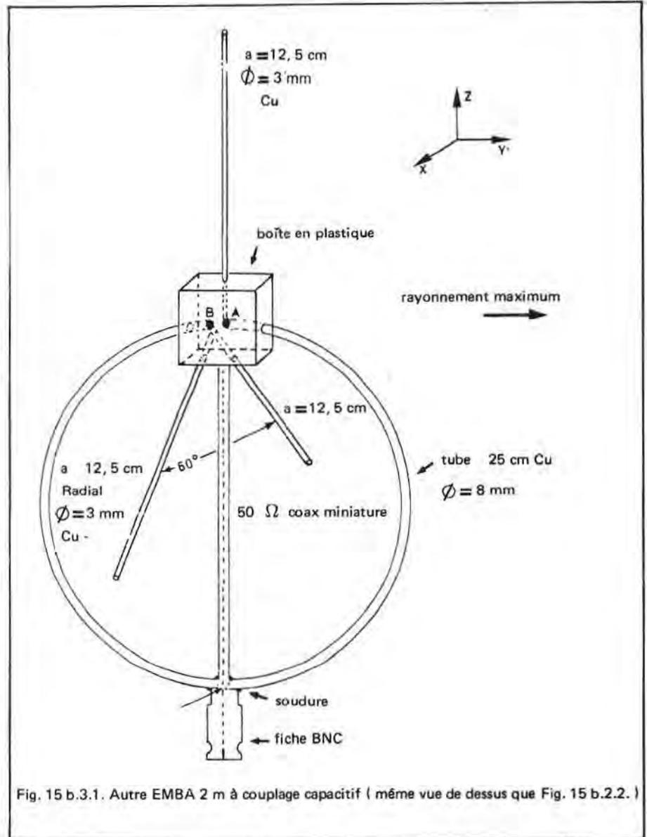
Fig. 15 b.3.1. Autre EMBA 2 m à couplage capacitif (même vue de dessus que Fig. 15 b.2.2.)
