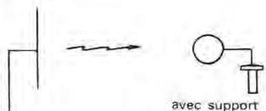
S'il s'agit d'un cadre symétrisé (du type décrit dans l'instruction technique n° 11 de l'arrêté du 7 décembre 1977 (1) relatifs aux récepteurs radio) la relation simplifiée entre la tension recueillie et mesurée sur une impédance de 50 ohms et la valeur du champ est :
