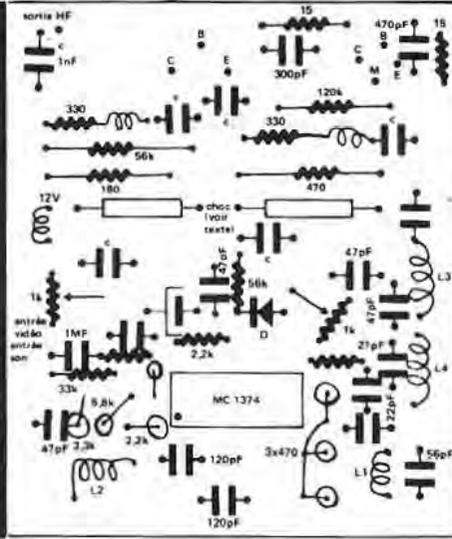
TV et en le limitant à la bande I (autour de 60 Mhz par exemple) on rayonne l'image et le son à plusieurs dizaines de mètres avec un simple bout de fil pour antenne permettant de visionner un magnétoscope ou une caméra (dite HF) dans un appartement sans être tributaire de câbles.
