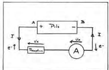
A l'intérieur, les électrons auront tendance à passer du pôle B vers le pôle A pour combler le manque en A jusqu'à l'équilibre.
