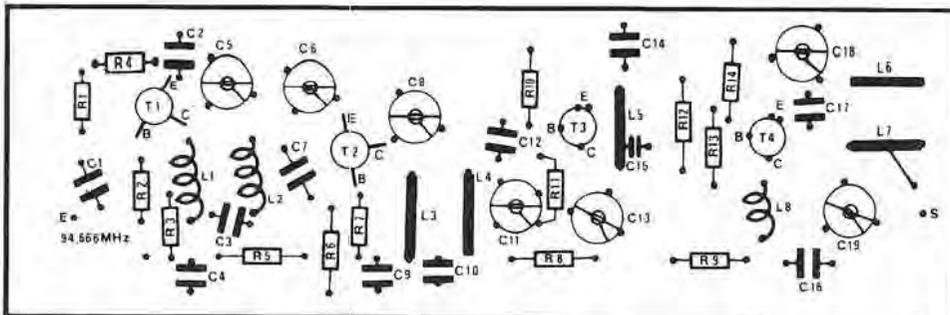
NOTE : L'intégralité du cuivre est conservée à la partie supérieure côté composants. Seuls les trous correspondants aux pattes des composants non reliés à la masse sont fraisés, la partie imprimée se trouvant au-dessous.
