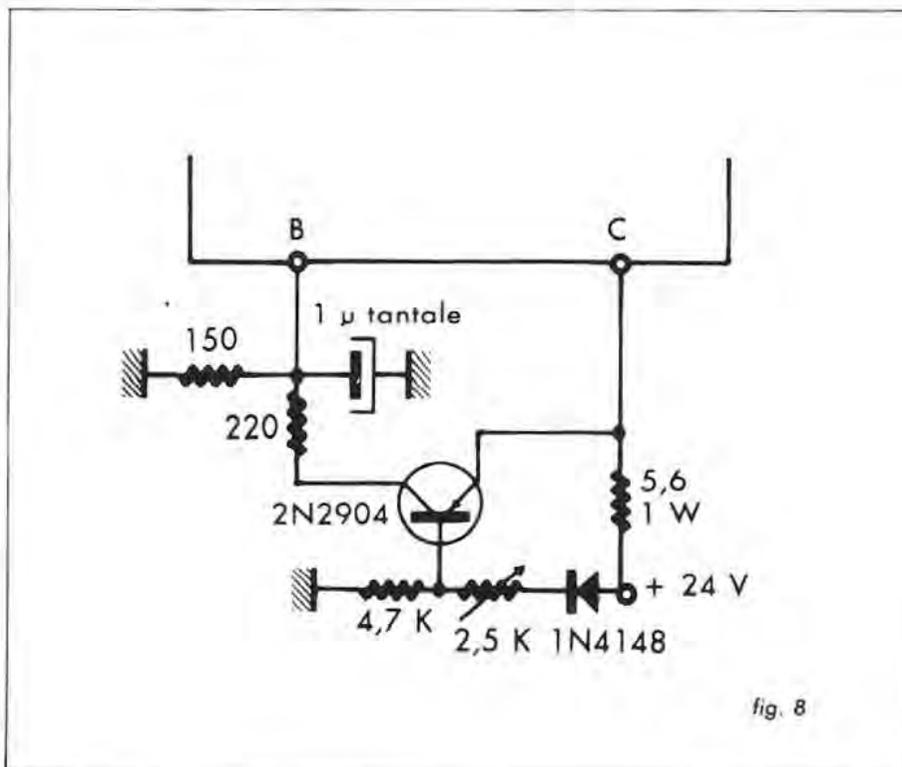
Dans le cas où l'on voudrait placer le transistor en classe A, il faut réaliser le montage figure 8, soit en l'air soit sur un petit morceau de veroboard ou autre substrat tout préparé. Le courant se règle à 440 mA à l'aide du potentiomètre de 2,5 K $\Omega$ .
