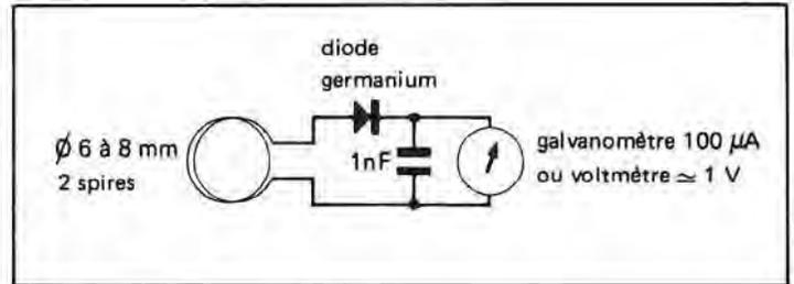
Si l'on ne possède pas de fréquencemètre, il est bon et même recommandé de construire un ondemètre à ligne (pour exemple celui décrit dans VHF/UHF manuel du RSGB «SM électronique à Auxerre»). Celui-ci étant pratiquement indispensable pour le réglage de l'étage tripleur 378/1136 MHz. De plus, étant donné les descriptions de plus en plus nombreuses concernant les fréquences supérieures au GHz, vous n'aurez pas à le regretter.
