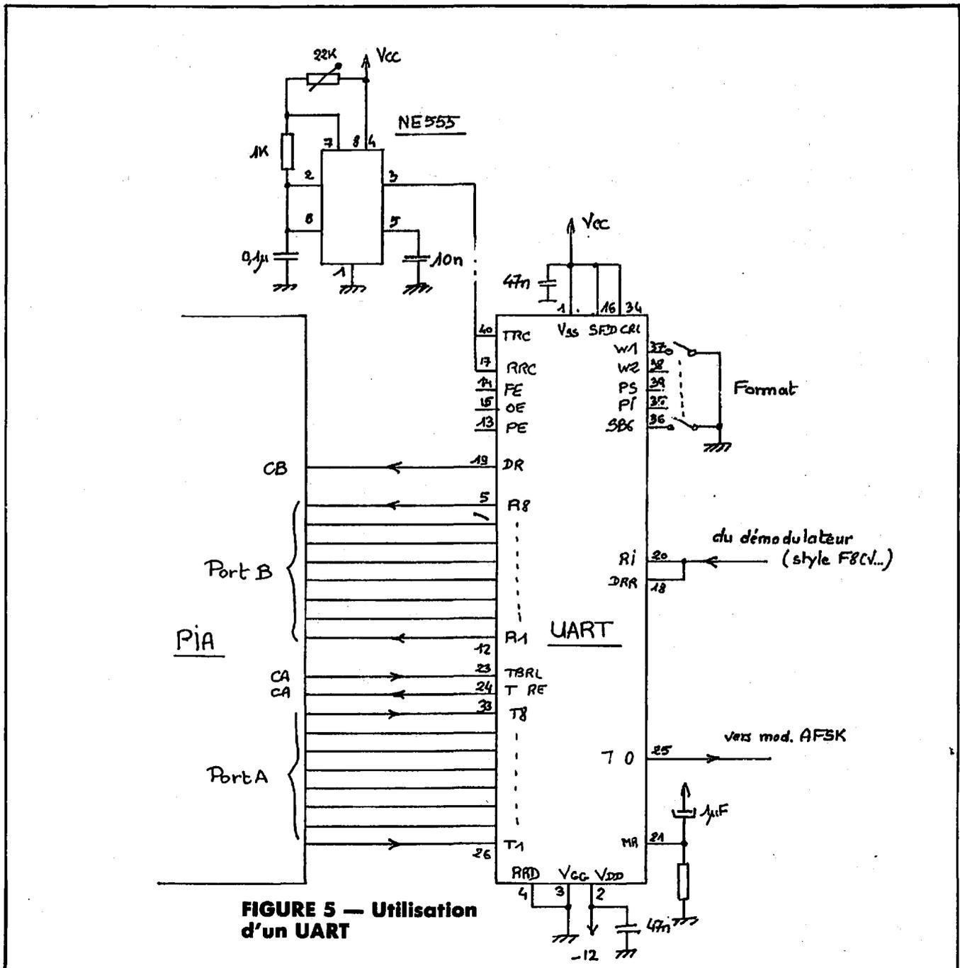
**FIGURE 5 — Utilisation d'un UART**
