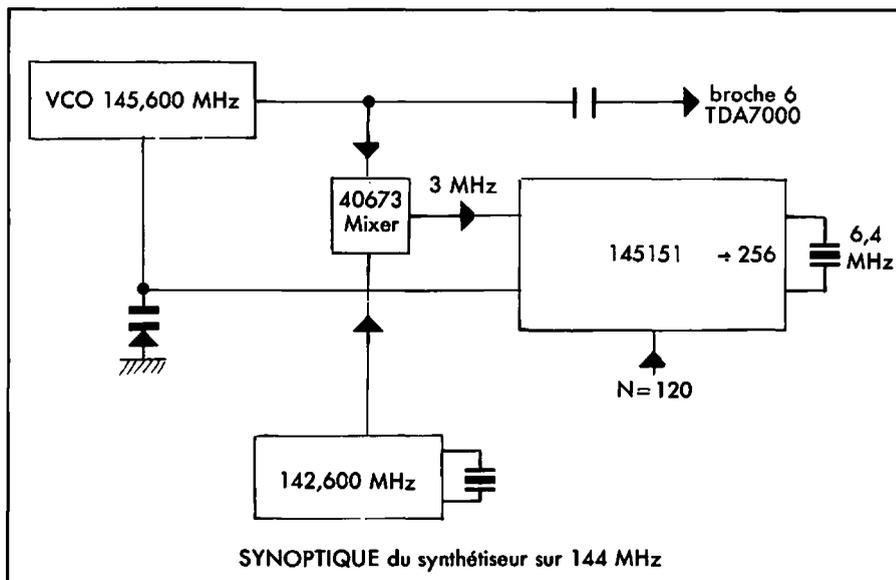
bien occupé, nous en donnerons le plan de réalisation ultérieurement. L'absence de filtre à quartz, le peu de moyens nécessaires pour un bon fonctionnement : un seul quartz ou fréquence de synthét. pour l'émission/réception, la quasi-ignorance de la fréquence image, autant d'éléments qui militent pour l'emploi d'un tel circuit.
