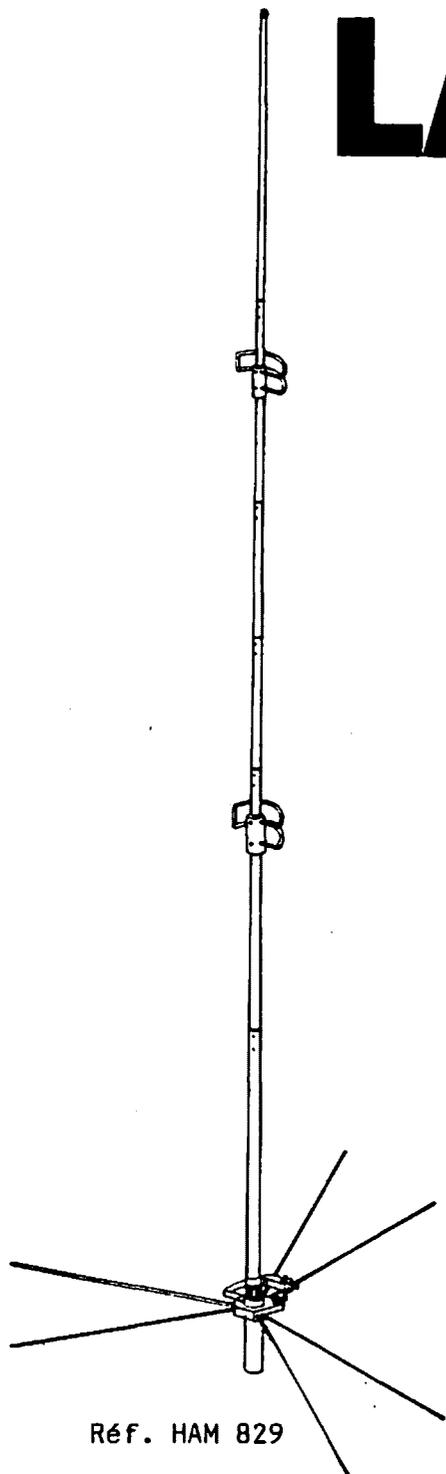
Une antenne de base colinéaire : omnidirectionnelle avec un gain de 6,5 dB.
