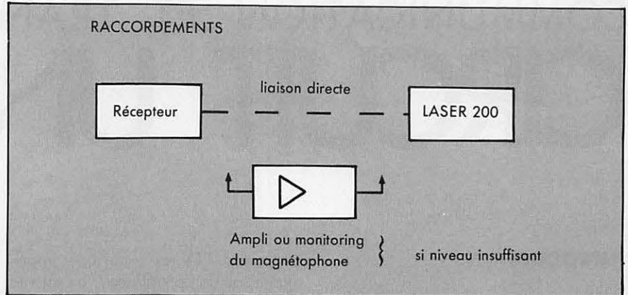
Suivant le niveau disponible à la sortie du récepteur, utiliser une liaison directe ou via un petit ampli.
