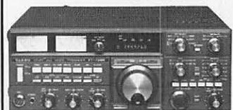
**FT 726R.** Emetteur-récepteur 144/432MHz. Duplex intégral VHF/UHF. Tous modes. 10W. Alimentation secteur et 12V DC. Récepteur satellite en option. 432MHz en option.
