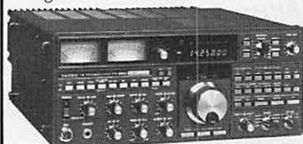
**FT 980.** Récepteur 150kHz à 30MHz. Emetteur bandes amateurs. Tous modes AM/FM/SSB/CW/FSK. 120W HF. Tout transistors. Option interface de télécommande par ordinateur (Apple//).
