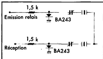
Il est préférable d'utiliser des diodes spécialisées pour les commutations type BA243.
