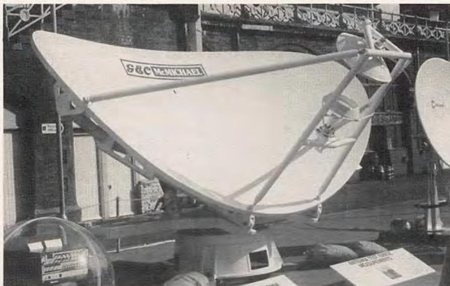
Antenne pour la réception de transmission satellite dans la bande des 11 GHz vue à l'exposition IBC. L'arrivée d'un si grand nombre de signaux TV par satellite, risque-t-elle de changer la définition du mot « DX » ?
