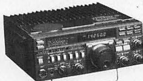
**FT 757GX.** Récepteur à couverture générale. Emetteur bandes amateurs. Tous modes AM/FM/SSB/CW/FSK. Alim. 13.4V DC. 100W. Dimensions: 238x93x238mm. Poids: 4,5kg. Option interface de télécommande par ordinateur (Apple//).
