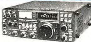
**.IC 751:** transceiver à couverture générale de 2<sup>e</sup> génération. Tous modes. 32 mémoires. 2 VFO'S. Réception, 4 changements de fréquences. Possibilité d'alim. 220 V incorporée. Livre complet, prêt à fonctionner, micro compris.
