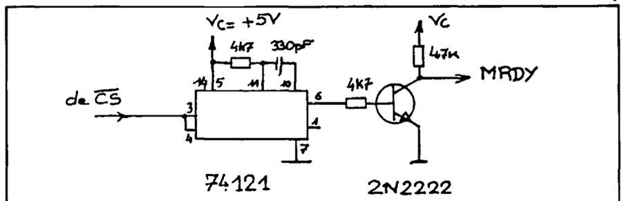
Figure 5 — Ralentisseur d'horloge
