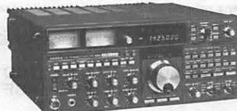
**YAESU - FT 980.** Transceiver décimétrique couverture générale de 150 kHz à 30 MHz en réception, émission bandes amateurs, tous modes, 120 W HF, tout transistor, alimentation 220 V. Option interface Apple II.
