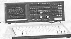
**TONO - 5000E.** Codeur-décodeur pour émission-réception en CW, RTTY (Baudot & ASCII) et AMTOR.
