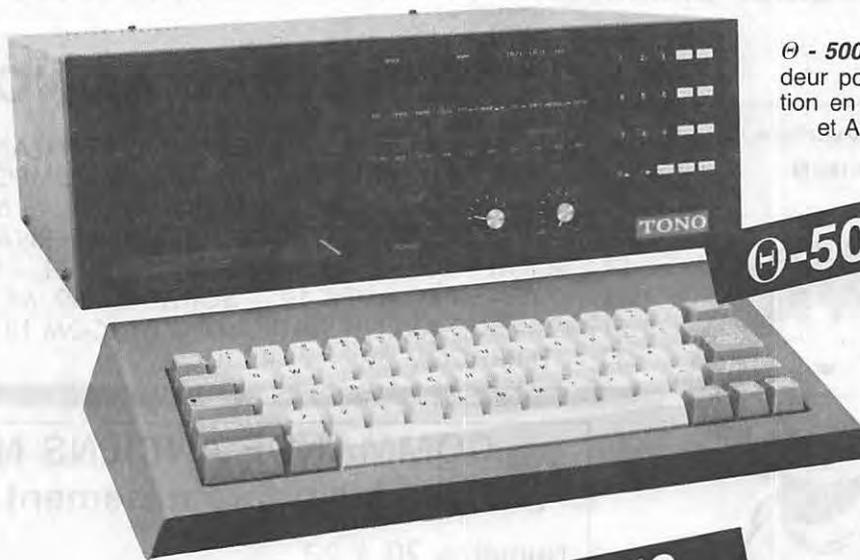
Θ - 5000E — Codeur décodeur pour l'émission réception en CW, RTTY (Baudot et ASCII) et AMTOR.
