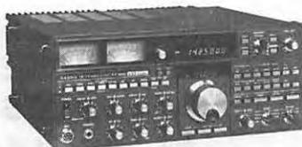
**YAESU - FT 980.** Transceiver décimétrique couverture générale de 150 kHz à 30 MHz en réception, émission bandes amateurs, tous modes, 120 W HF, tout transistor, alimentation 220 V. Option interface Apple II.
