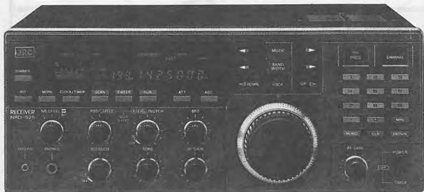
Récepteur à couverture générale de 90 kHz à 34 MHz et de 34 MHz à 60 MHz. Modes AM, USB, LSB, CW, RTTY, FAX, FM. 200 mémoires. Alimentation secteur et DC. Double horloge. Notch. PBS.
