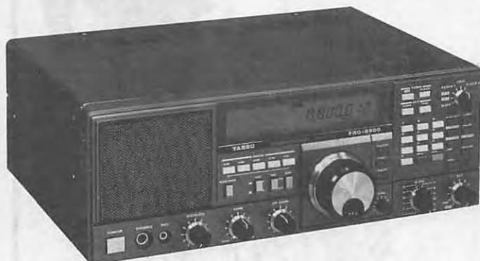
**YAESU - FRG 8800.** Récepteur à couverture générale de 150 kHz à 30 MHz. Tous modes. 12 mémoires. Double horloge. Interface de télécommande par ordinateur. Convertisseur VHF 118 à 174 MHz en option.
