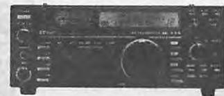
**YAESU - FT 726R.** Transceiver 144 MHz / 432 MHz. Tous modes. 10 W. 220 V et 12 V. Options : réception satellites et 432 MHz.
