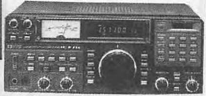
**ICOM - ICR 71E.** Récepteur tous modes de 100 kHz à 30 MHz, modes SSB/AM/RTTY/CW, FM en option. De nombreuses innovations techniques.
