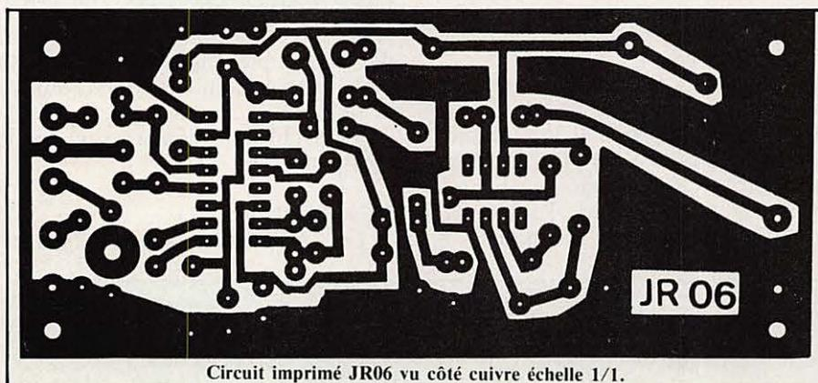
Circuit imprimé JR06 vu côté cuivre échelle 1/1.
