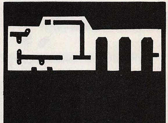
Photo 10 : Vue du tripleur 378/1136 MHz 100 mW HF
