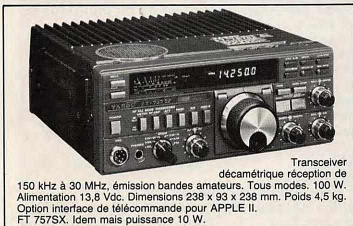
Transceiver décimétrique réception de 150 kHz à 30 MHz, émission bandes amateurs. Tous modes. 100 W. Alimentation 13,8 Vdc. Dimensions 238 x 93 x 238 mm. Poids 4,5 kg. Option interface de télécommande pour APPLE II. FT 757SX. Idem mais puissance 10 W.
