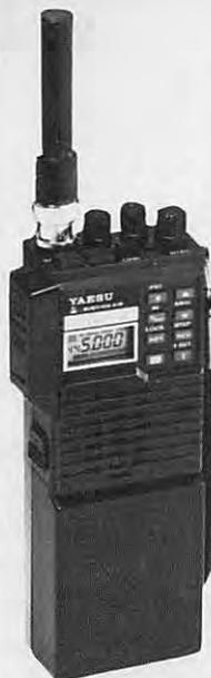
**FT 23R** - Transceiver portable FM 144-146 MHz. 10 mémoires avec shift dont 7 programmables avec des shifts non standard. Scanning. Affichage LCD des fréquences et mémoires et par bar-graph pour le signal reçu. Boîtier métallique. Puissance : 2 à 5 W\*. Dimensions : 55 x 32 x 122/139/188\*. Poids : 430 à 550 g\*.
