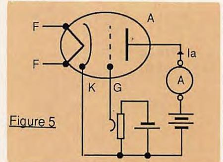
Caractéristiques de transfert d'un tube triode
