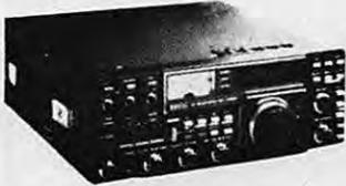
**YAESU - FT 726R.** Transceiver 144 MHz / 432 MHz. Tous modes. 10 W, 220 V et 12 V. Options : réception satellites et 432 MHz.
