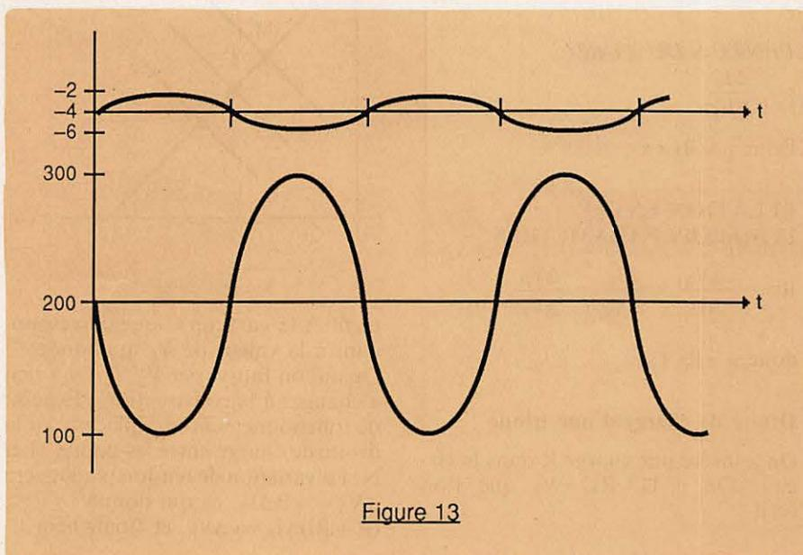
De plus, même si les échelles sont différentes, on conçoit que la tension de sortie ( $V_a$ ) soit beaucoup plus grande que la tension d'entrée ( $V_g$ )
