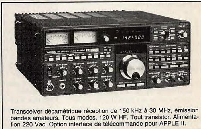
Transceiver décimétrique réception de 150 kHz à 30 MHz, émission bandes amateurs. Tous modes. 120 W HF. Tout transistor. Alimentation 220 Vac. Option interface de télécommande pour APPLE II.
