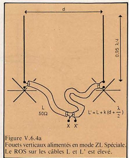
Le signal est appliqué en XX' à travers une boîte asymétrique-permettant d'obtenir un ROS de 1 sur le câble coaxial venant de l'émetteur.
