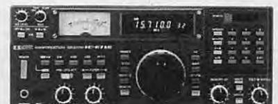
**ICOM - ICR 71E.** Récepteur tous modes de 100 kHz à 30 MHz, modes SSB/AM/RTTY/CW, FM en option. De nombreuses innovations techniques.
