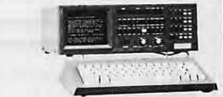
**TONO - 5000E.** Codeur-Décodeur pour émission-réception en CW, RTTY (Baudot & ASCII) et AMTOR.
