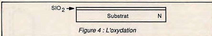
Figure 4 : L'oxydation
