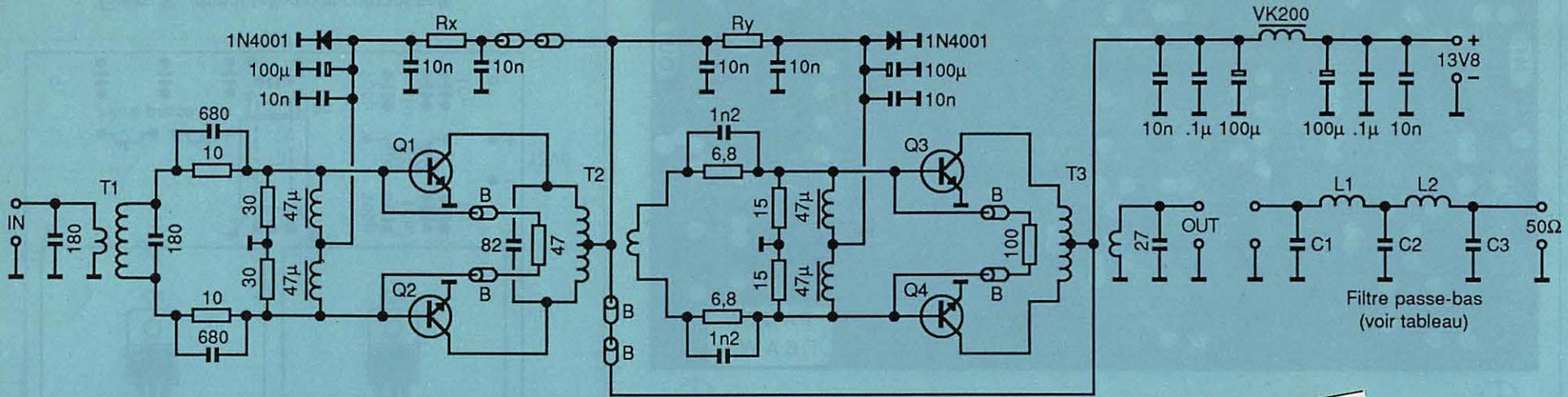
Figure 1 : Schéma théorique de l'amplificateur
