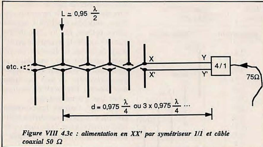
Figure VIII 4.3c : alimentation en XX' par symétriseur 1/1 et câble coaxial 50 Ω
