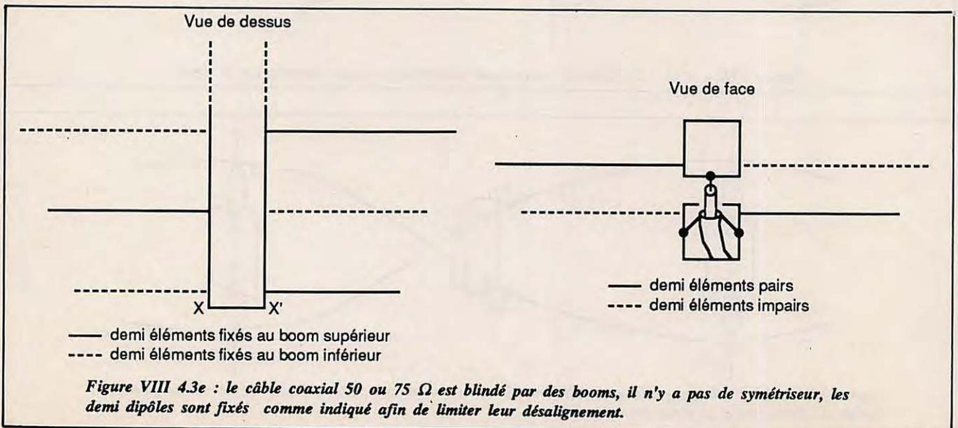
Figure VIII 4.3e : le câble coaxial 50 ou 75 Ω est blindé par des booms, il n'y a pas de symétriseur, les demi dipôles sont fixés comme indiqué afin de limiter leur désalignement.
