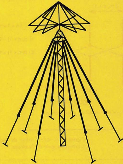
Figure VIII - 3c : antenne Discone pour bandes basses décamétriques.
