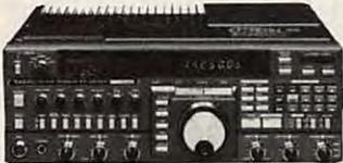
**YAESU - FT 757GX.** Transceiver décimétrique couverture générale de 500 kHz à 30 MHz en réception, émission bandes amateurs. Tous modes. 100 W. Alimentation 13,8 Vdc. Dimensions 238 x 93 x 238 mm, poids 4,5 kg. Option interface de télécommande pour Apple II.
