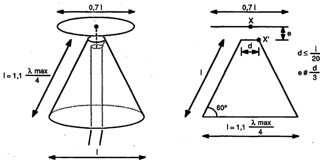
Figure VIII - 3a : vues de l'antenne Discone
