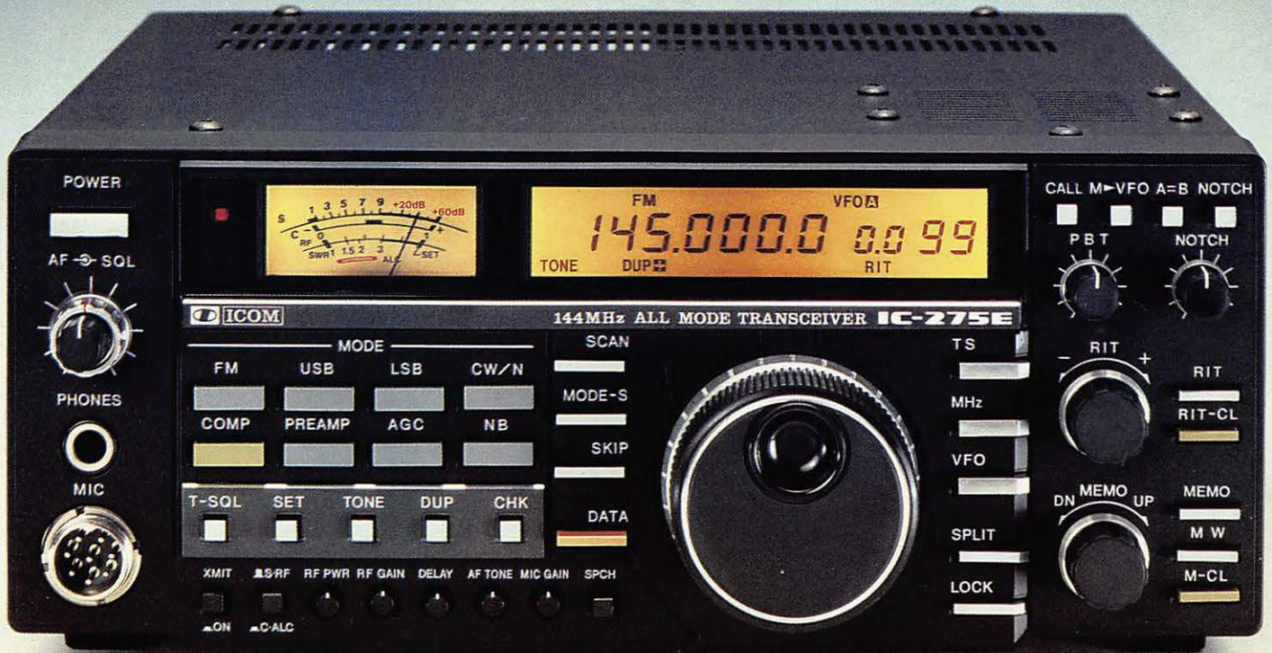
L'IC-275 E est équipé du système ICOM DDS (Direct Digital Synthesiser) permettant un verrouillage en moins de 5 millisecondes. De ce fait, il est l'outil idéal pour qui pratique les modes PACKET et AMTOR\*. Ce système a été mis au point par ICOM autour d'un PLL «High Grade» qui mélange en un temps infiniment court les fréquences synthétisées émanant du DDS dans un système à deux boucles de phase.
