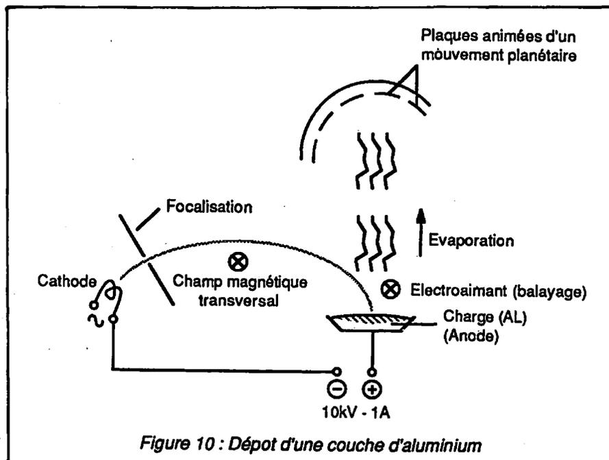
Figure 10 : Dépôt d'une couche d'aluminium
