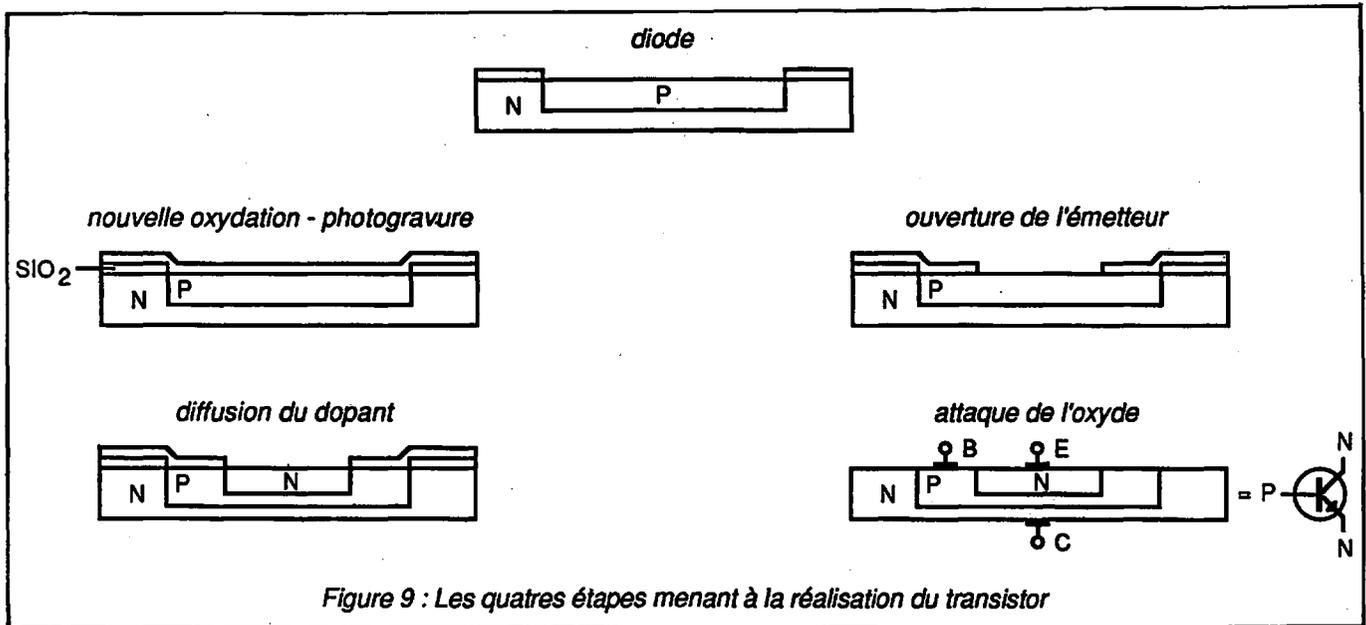
Figure 9 : Les quatres étapes menant à la réalisation du transistor
