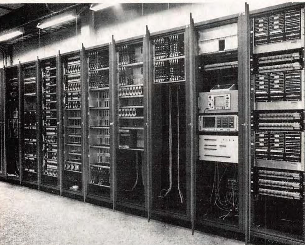
à la commande et au contrôle du standard, mais peuvent également remplir d'autres fonctions. Le système met en œuvre trois ordinateurs VAX placés dans une centrale. Deux ordinateurs gèrent le standard et les terminaux d'opérateurs, tandis que le troisième sert au stockage des informations et fait office d'ordinateur de secours. Les trois ordinateurs sont reliés entre eux par un réseau DECnet.
