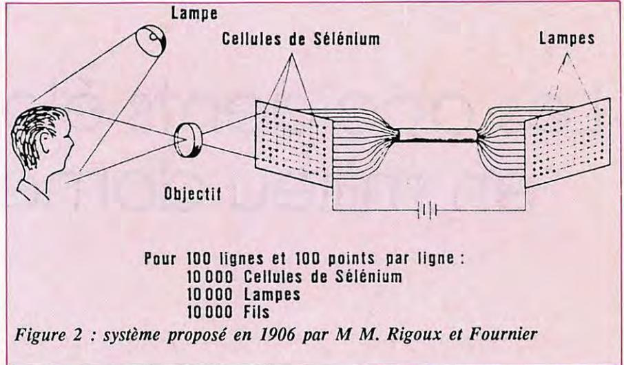
Figure 2 : système proposé en 1906 par M. M. Rigoux et Fournier
