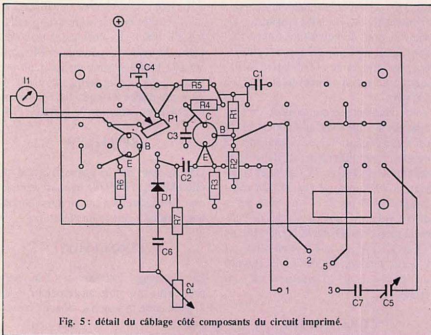
Fig. 5 : détail du câblage côté composants du circuit imprimé.
