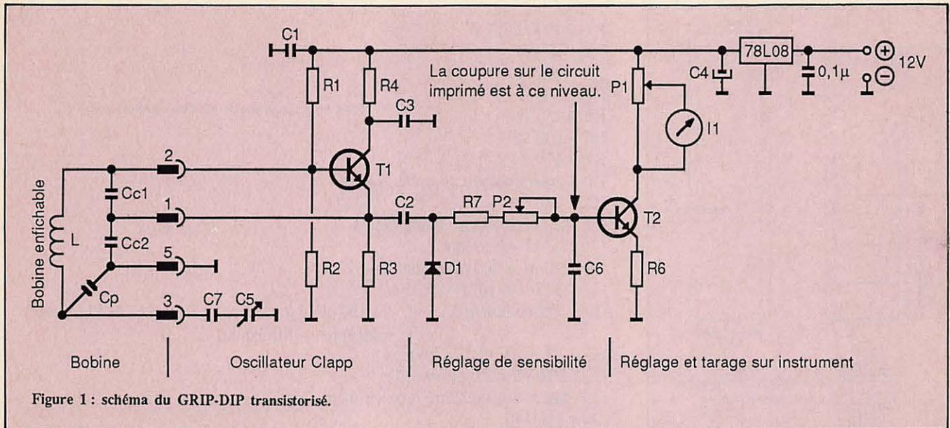
Figure 1 : schéma du GRIP-DIP transistorisé.
