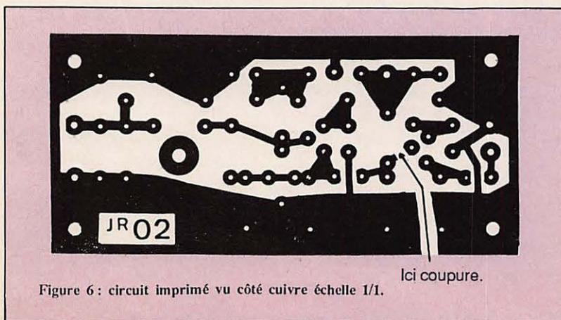
Figure 6 : circuit imprimé vu côté cuivre échelle 1/1.
