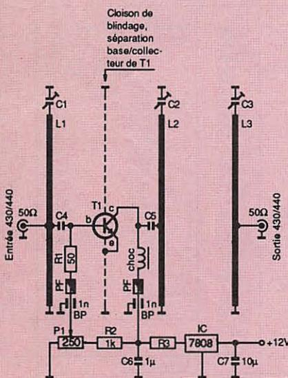
Figure 1 : Schéma de base du préampli 430/440 MHz.
