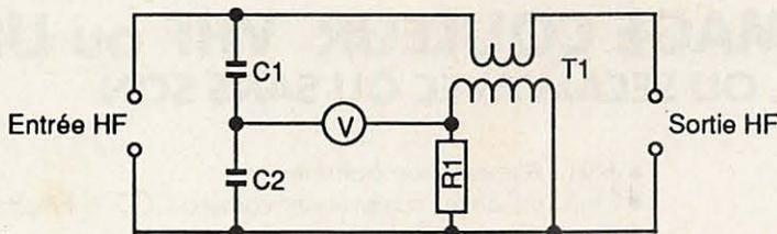
Figure 2 : Principe du pont de mesure
