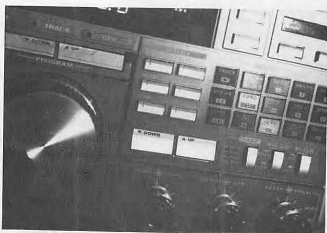
Photo n° 5 : Les commandes de changement de fréquence
