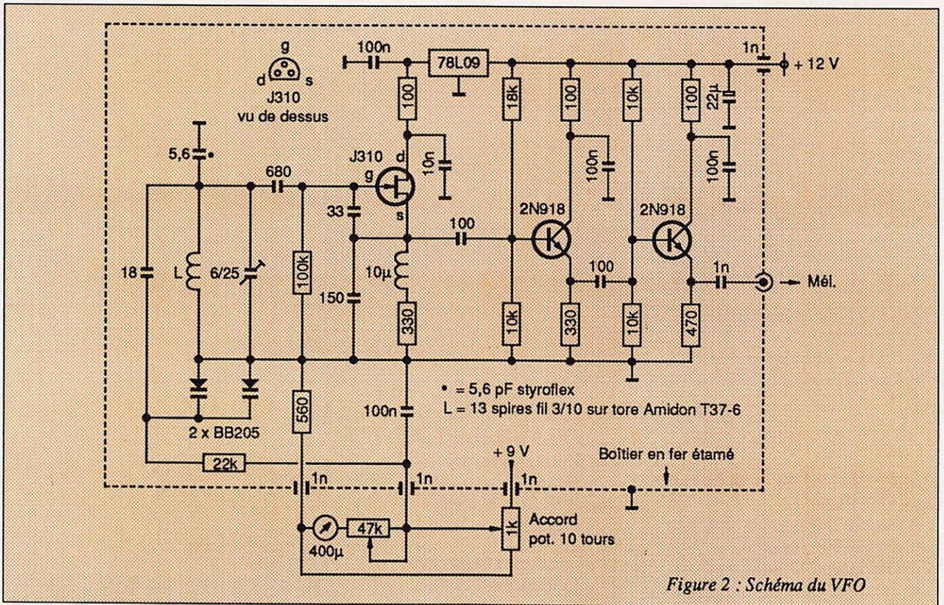
Figure 2 : Schéma du VFO
