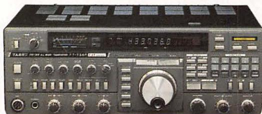
Transceiver tous modes. 144 MHz et 430 MHz (25 w) Alim. secteur et 12 Vdc. Options : 50 MHz (10 w) 1200 MHz (10 w) - ATV 1200 MHz
