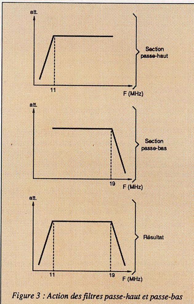
Figure 3 : Action des filtres passe-haut et passe-bas
