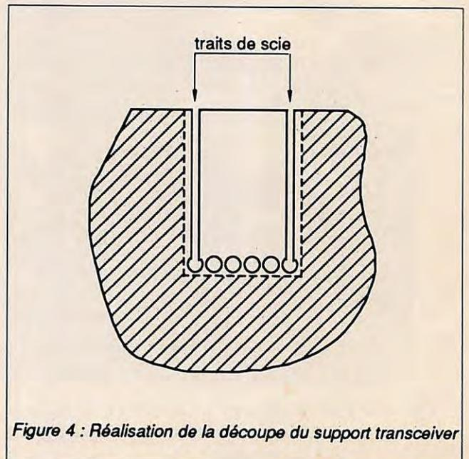
Figure 4 : Réalisation de la découpe du support transceiver
