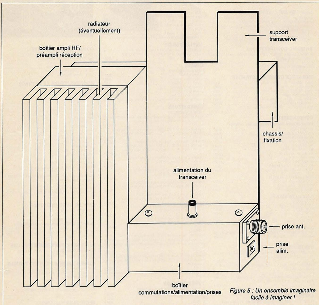
FT-208 et réglez-le bien vertical. A ce moment seulement, bloquez les 3 vis. Le FT-208 doit rentrer sans forcer, son attache de ceinture doit passer par dessus le support, la partie supérieure venant se loger dans la découpe. La rentrée dans la prise alimentation doit se faire sans peine.
