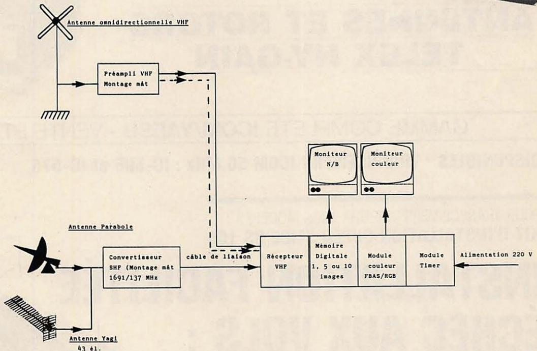
*Schéma synoptique d'une station, avec l'option des satellites à défilement*
