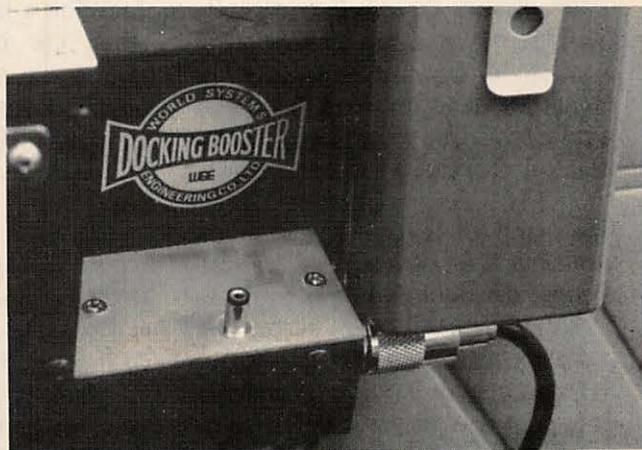
Photo 2 : Le support alimenté. On peut remarquer que le trou de passage de la prise a été fraisé au foret pour que le socle de prise ne dépasse pas de la surface de la platine.
