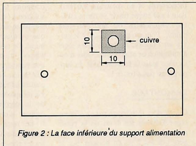
Figure 2 : La face inférieure du support alimenté
