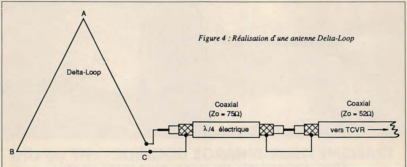
Figure 4 : Réalisation d'une antenne Delta-Loop
