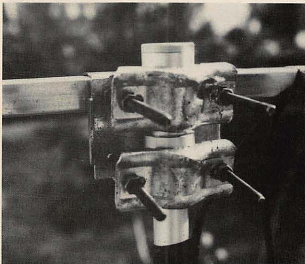
Sur la photo 5, la fixation de l'antenne avec une partie mobile permettant le réglage en fonction du diamètre du mât. Des vis papillon seraient sûrement préférables à nos écrous, surtout en pleine campagne !
