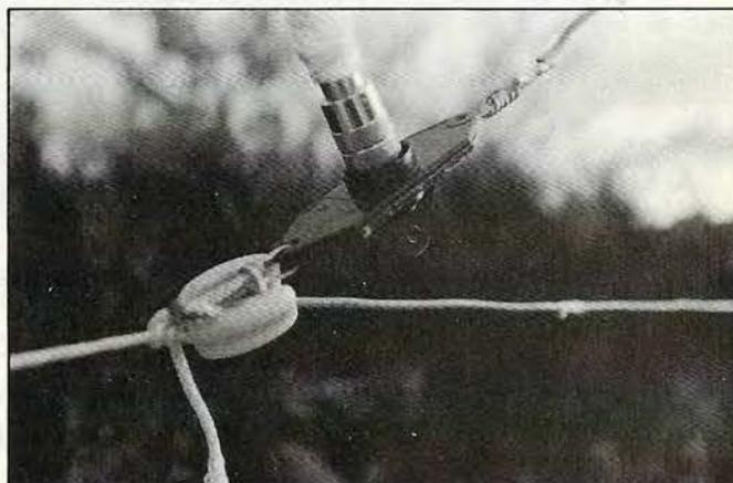
L'isolateur central (sur le côté du triangle et non sur la base) : l'arrivée du coaxial 75 ohms.
