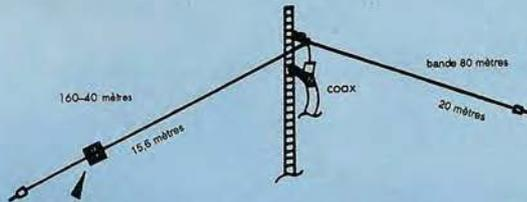
De réputation mondiale, ce sloper est déjà très utilisé en France par les DXeurs. Il permet un excellent trafic sur ces bandes et peut être utilisé en portable ou en expédition.
