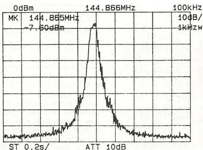
Spectre de la porteuse HF à 100 kHz.
