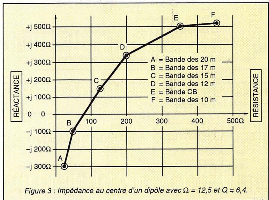
Figure 3 : Impédance au centre d'un dipôle avec  $\Omega = 12,5$  et  $Q = 6,4$ .
